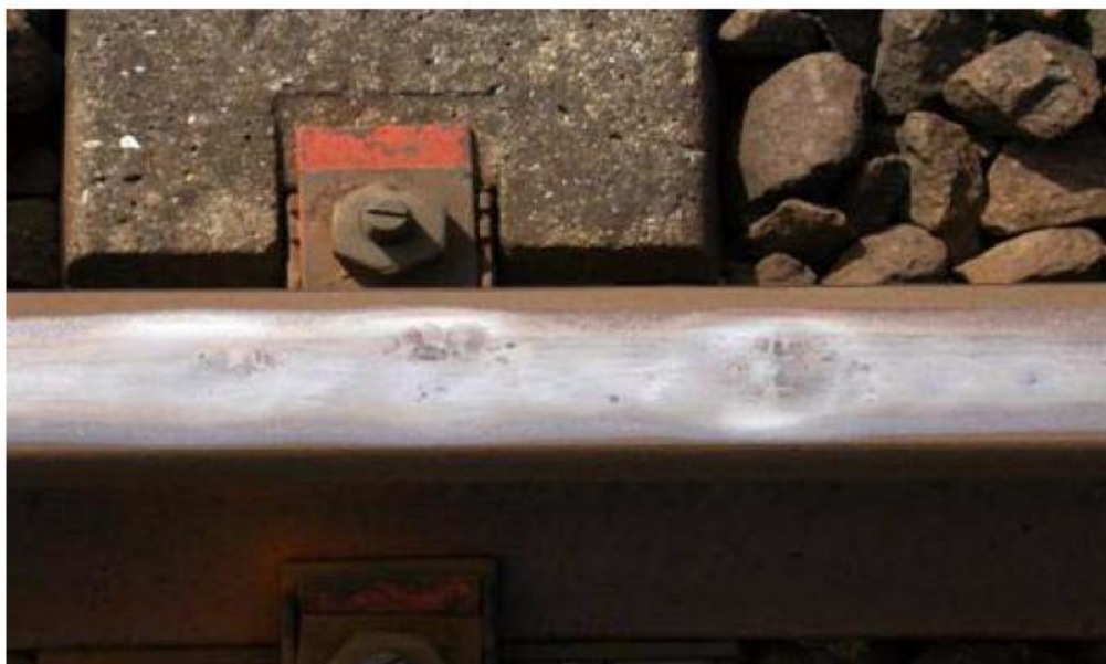
شکل ۱۳ - در اغلب موارد، چند اسکات با هم اتفاق می افتند
