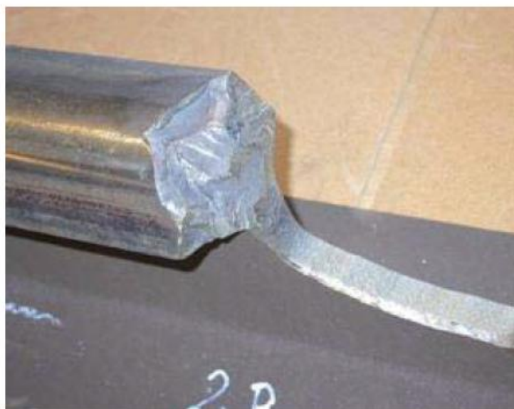
شکل ۱۲ - مثال شکست ریل به واسطه وجود اسکات
