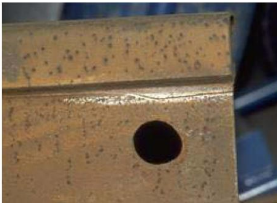
شکل ۵ - مثال نوعی از ترک افقی در انتهای ریل
