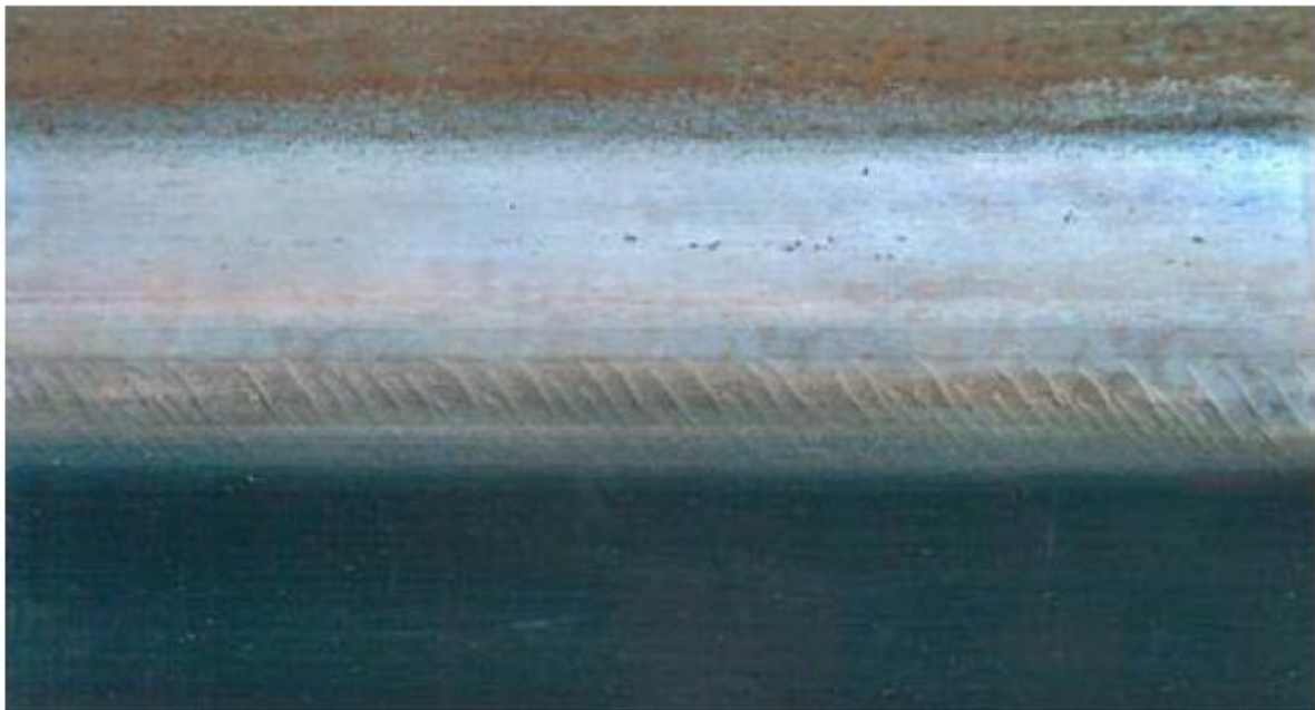
شکل ۱۰- مثال نوعی از شکافهای موازی سطحی در ریل بالایی قوس
