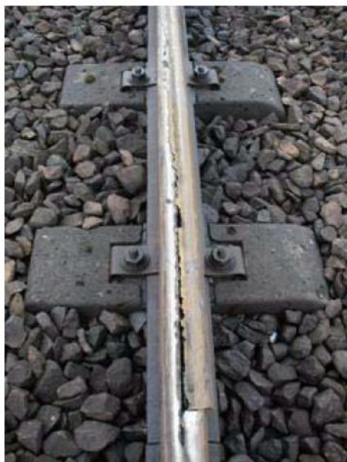
شکل ۷ و ۸ - مثال های ترک های عمودی طولی که طول آنها به وضوح قابل مشاهده بوده است.
