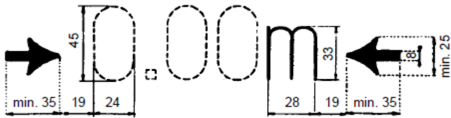
شکل ح-۴۱ - علامت نشان دهنده فاصله بین محورهای انتهایی بوژی ها و واگنهای بدون بوژی و بین کاسه بوژی
