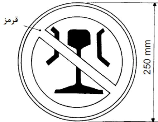
شکل ح-۳۱ - واگنهایی که مجاز به عبور از طریق ریتارد در یا سایر قطعات ایست کننده در حالت سرویس نمی باشند.
