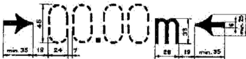
شکل خ-۲- علامت بوژی نشان دهنده گام نامی و فاصله چرخ‌ها
