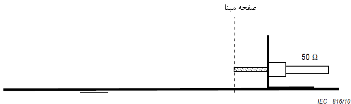
شکل ۲۴ ب - تنظیمات برای اندازه‌گیری واسنجی منعکس پورت B
