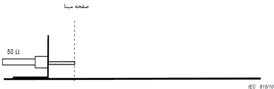
شکل ۲۴ الف - تنظیمات برای اندازه‌گیری واسنجی منعکس پورت A
