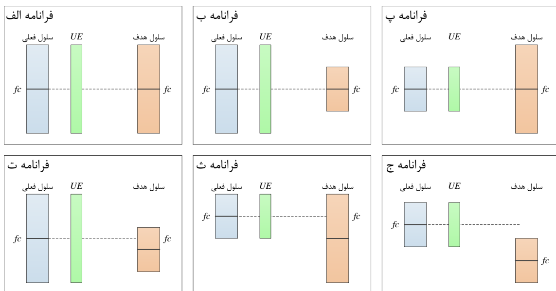
شکل ۵۶- فرانامه‌های اندازه گیری بین بسامدی و داخل بسامدی
