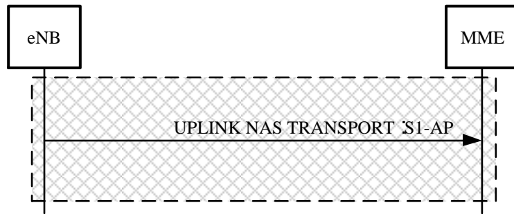
شکل ۱۰۸- رویه حمل NAS پیوند فراسو
