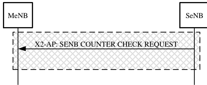
شکل ۱۵۱- رویه بررسی شمارنده SeNB
