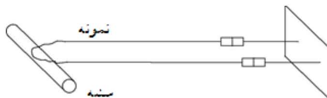
شکل ۱ - نمونه ثابت شده روی سنبه
