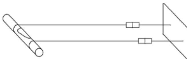
شکل ۲ - کابل پیچیده شده حول سنبه
