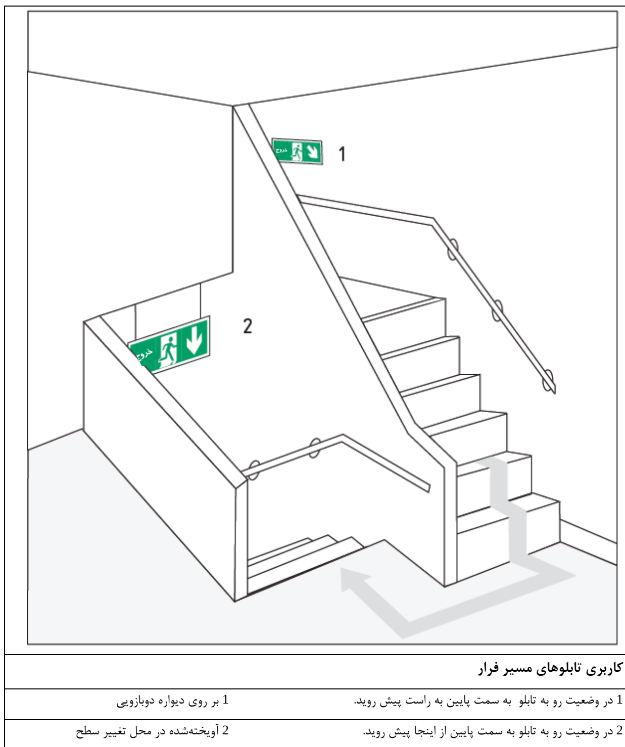
شکل الف-۳-پلکان نیم طبقه نشان دهنده کاربری درست تابلو(های) مسیر فرار همراه با متن مکمل
