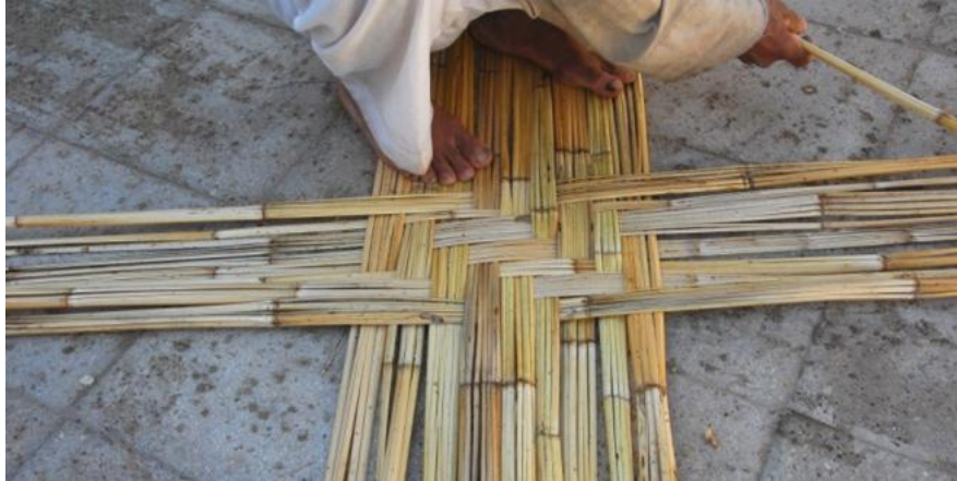
شکل ۴۰- استقرار هفتمین نوار پود در میان نوارهای تار
