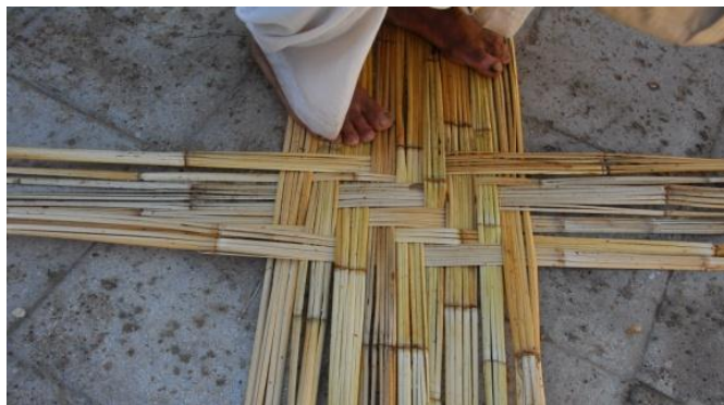
شکل ۳۹- استقرار ششمین نوار پود در میان نوارهای تار
