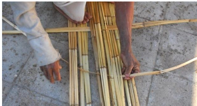
شکل ۳۵- استقرار دومین نوار پود در میان نوارهای تار
