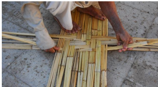
شکل ۳۸- استقرار پنجمین نوار پود در میان نوارهای تار
