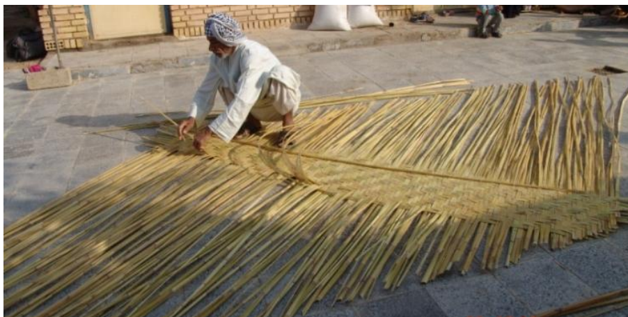
شکل ۴۱- استقرار تمام نوارهای پود و ایجاد سطح متوازی الاضلاع
