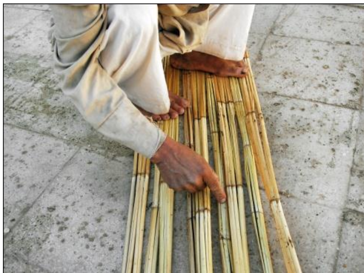
شکل ۳۳- استقرار ۹ عدد نوار تار روی زمین
