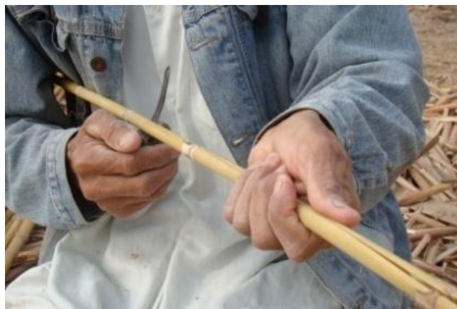
شکل ۱۴- شکافتن (دونیم کردن) ساقه نی به وسیله مشگه
