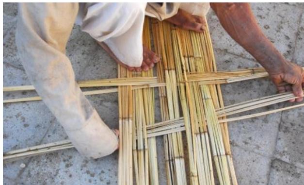
شکل ۳۶- استقرار سومین نوار پود در میان نوارهای تار
