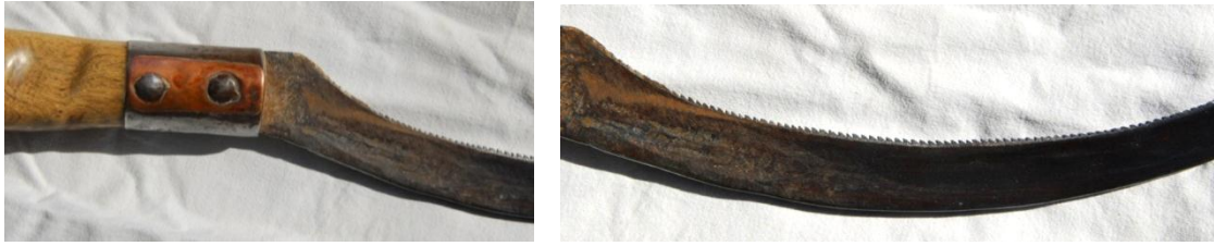
شکل ۱۲- تیغه منجل و محل اتصال آن به دسته منجل
