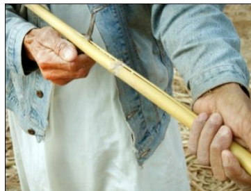
شکل ۲۷- دونیم کردن ساقه نی با استفاده از مشگه
