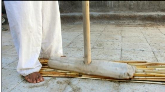
شکل ۲۹- کوبیدن و مسطح کردن ساقه‌های نی با مدگه
