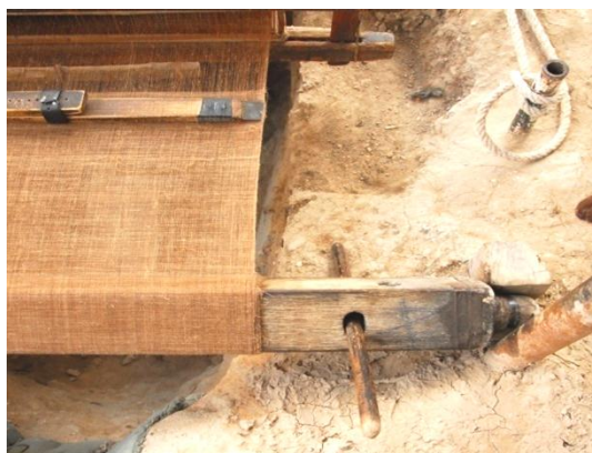
شکل ۱۱۱ - ثابت کردن نورد با استفاده از مل پیچ
