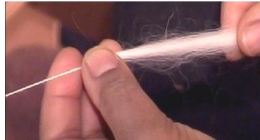
شکل ۶۳- ایجاد نخ اولیه با پیچش و کشش الیاف پشم
