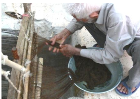
شکل ۹۲ - آغشته کردن نخ‌های تار به محلول آب و شیرۀ خرما
