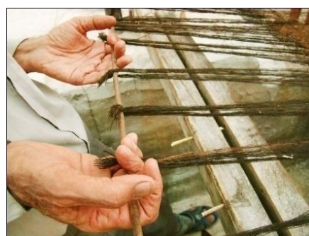
شکل ۹۰- قرار گرفتن و ثابت شدن میله نگه‌دارنده نخ‌های تار درون شیار نورد
