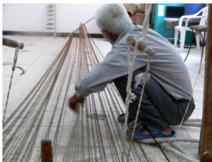
شکل ۱۰۰- تفکیک نخ های تار روی چوب سر کار
