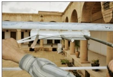
شکل ۸۲- حرکت مجدد گروه نخ‌ها از بالا به پایین، در بین دو ستون مستقر در سمت چپ و راست
