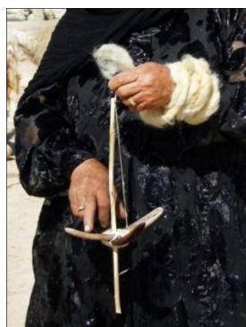
شکل ۶۷- چرخاندن پره با دست راست در جهت عقربه‌های ساعت
