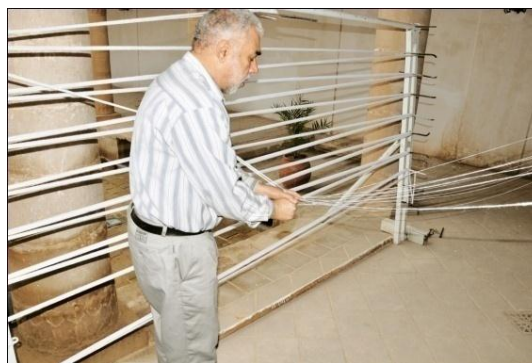
شکل ۸۰- زیر و رو کردن مجدد نخ‌ها به کمک انگشتان پس از پایان هر دور
