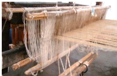
شکل ۸۷- عبور نخ‌های تار از میان اوزارها
