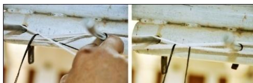
شکل ۸۴- گره‌زدن گروه نخ‌های زیر و رو در محل میله‌های تفکیک‌کننده به‌منظور ایجاد مشتی
