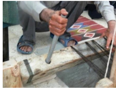
شکل ۹۸- چرخاندن نورد با مل پیچ به منظور کشیدن نخ های تار
