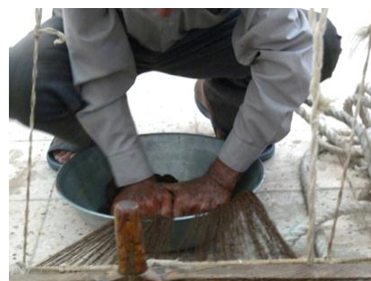
شکل ۹۲ - آغشته کردن نخ‌های تار به محلول آب و شیرۀ خرما
