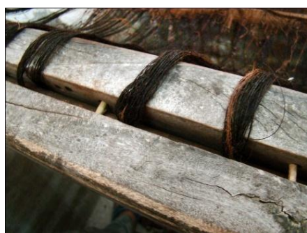
شکل ۹۰- قرار گرفتن و ثابت شدن میله نگه‌دارنده نخ‌های تار درون شیار نورد
