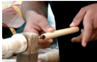
شکل ۱۰۲- شیوه استقرار بلول روی میل قرقره
