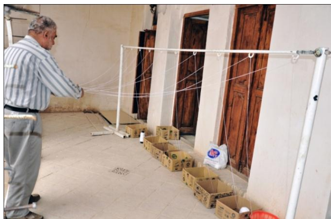
شکل ۷۳- قراردادن سر نخ‌ها در دست به منظور تعیین زیر و روی آنها با استفاده از انگشتان دست
