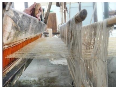
شکل ۸۸- عبور نخ‌های تار از میان لیت (شانه)
