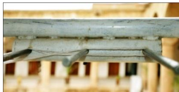
شکل ۷۵- جایگزینی میله‌های تفکیک‌کننده نخ‌های تار بالایی و پایینی با انگشتان
