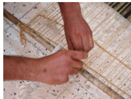
شکل ۱۰۰- تفکیک نخ های تار روی چوب سر کار
