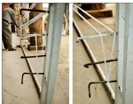
شکل ۷۷- موقعیت میله‌های سه‌گانه قلب روی دار چله‌دوانی
