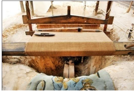
شکل ۲۷- پاچال و موقعیت آن نسبت به دستگاه (نمای بالا)
