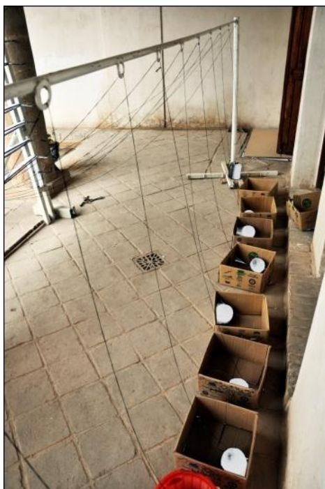
شکل ۷۲- استقرار نخ‌ها بر روی میله نگه‌دارنده نخ‌های چله‌دوانی
