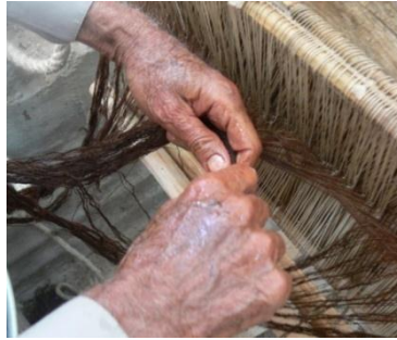
شکل ۹۴ - جدا کردن نخ‌های تار آهارخورده به وسیله انگشتان دست
