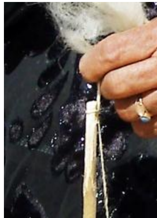
شکل ۶۵- گره زدن میانه نخ اولیه به شیار بالای محور مرکزی
