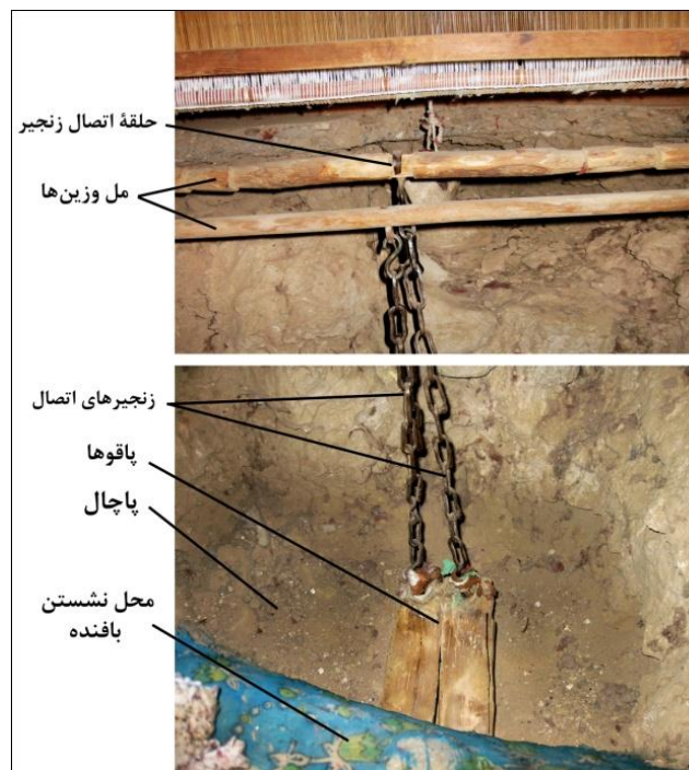
شکل ۵۱- موقعیت پاڤوها و مل وزین‌ها در دستگاه عبابافی
