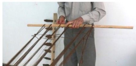
شکل ۹۵ - گره زدن نخ‌های تار آهارخورده به دور چوب سرکار
