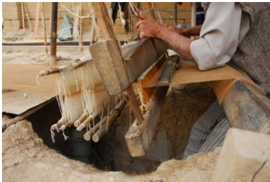
شکل ۱۰۸ - دفه زدن برای انسجام نخ پود با لبه منسوج
