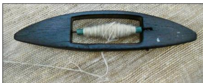
شکل ۱۸- ماکوی عبابافی با بلول پر شده در میان آن
