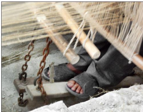
شکل ۱۰۴- فشار بر پا قوی اول به منظور باز کردن دهانه کار
