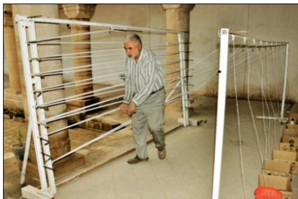
شکل ۹۸۵۰- همراهی دست به‌منظور جلوگیری از گم‌شدن مسیر چله‌دوانی
