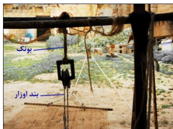
شکل ۴۶- موقعیت گنجیکک، بونک و بند اوزار در دستگاه عبابافی
