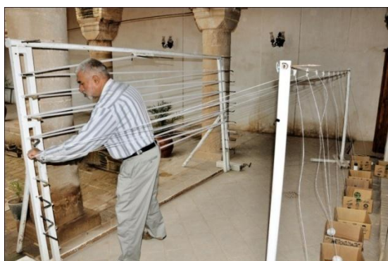
شکل ۷۶- رفت و آمد مداوم چله‌دوان از بالا به پایین، در بین دو ستون دار چله‌دوانی
