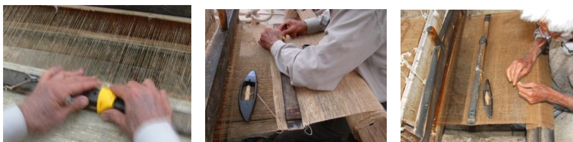
شکل ۱۱۰ - استقرار و تنظیم تیت روی منسوج
