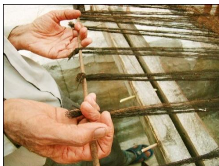
شکل ۸۹- بستن سر چله‌ها به میله نگه‌دارنده نخ‌های تار
