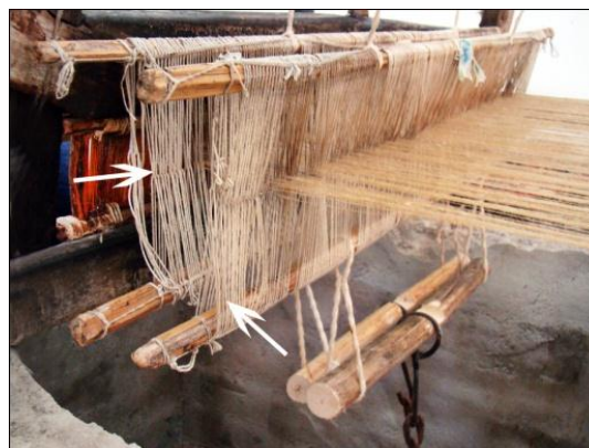
شکل ۴۴- موقعیت دو عدد اوزار در دستگاه عبابافی
