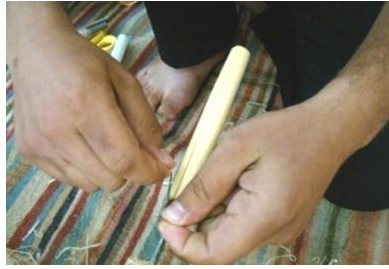
شکل ۱۰۱- شیوه استقرار نخ پود روی بلول
