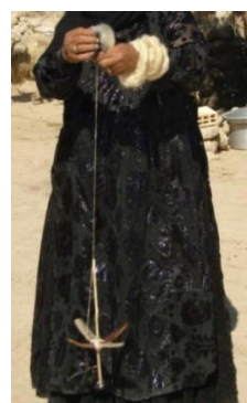
شکل ۶۸- بازکردن الیاف از روی فتیله و تبدیل آنها به نخ در اثر چرخش فتیله
