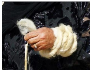
شکل ۶۶- بستن دنباله فتیله پشمی به دور ساعد دست چپ
