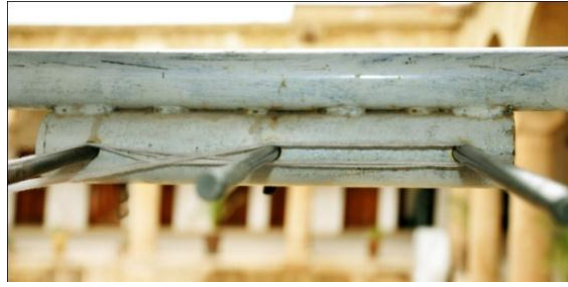
شکل ۲۳- میله‌های تفکیک‌کننده نخ‌های تار بالایی و پایینی
