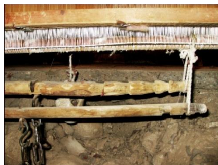
شکل ۴۸- موقعیت استقرار مل‌وزین در زیر اوزارها
