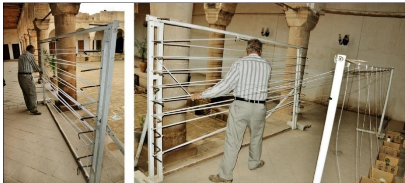
شکل ۷۹- حرکت نخ‌های تار از میله‌های قسمت قلب در پایین به سمت بالا
