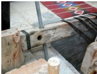
شکل ۹۸- چرخاندن نورد با مل پیچ به منظور کشیدن نخ های تار
