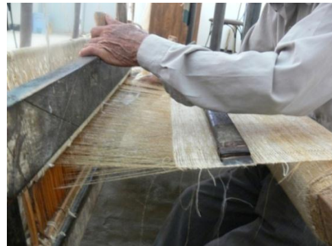
شکل ۱۰۸ - دفه زدن برای انسجام نخ پود با لبه منسوج
