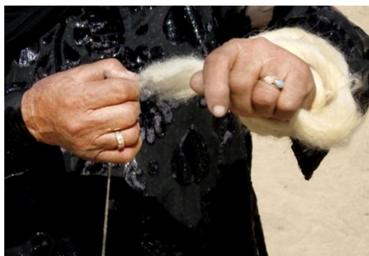
شکل ۶۸- بازکردن الیاف از روی فتیله و تبدیل آنها به نخ در اثر چرخش فتیله
