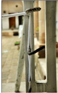
شکل ۷۸- شیوه استقرار نخ‌های تار روی میله‌های قلب
