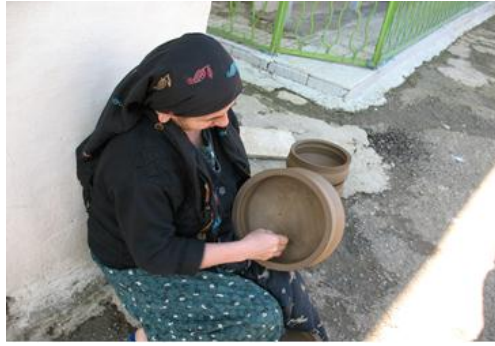
شکل ۱۷- هموار کردن سطح داخلی و خارجی شی نیمه خشک
