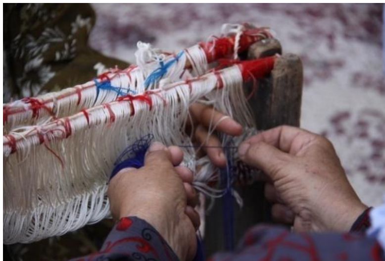
شکل ۲۴ - نمایی از رد کردن تار از ورد بوسیله انگشت
