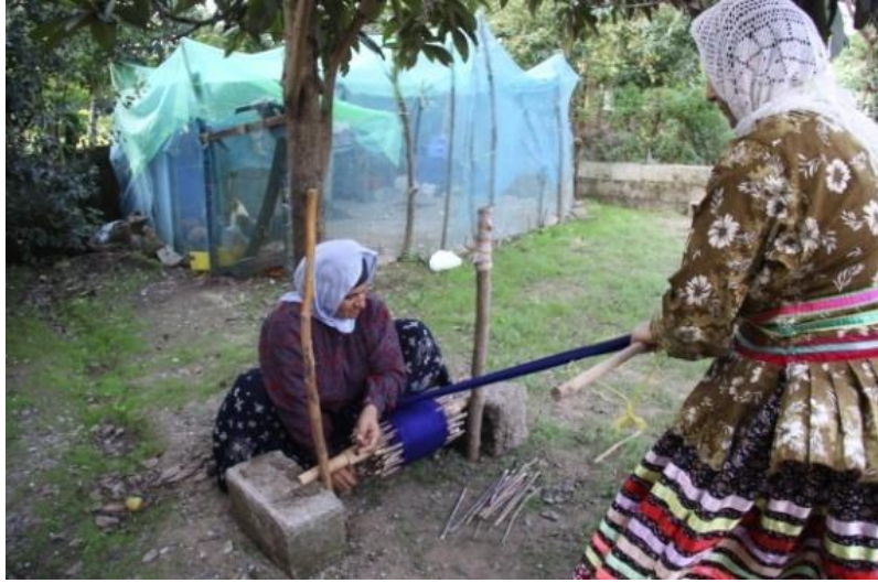
شکل ۲۱- نمایی از جمع کردن تارهای تنیده شده بر روی پس نورد با کمک چونگام
