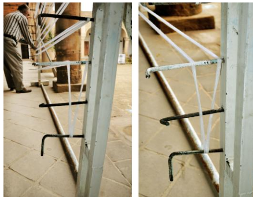
شکل ۵۱- موقعیت میله‌های سه‌گانه بخش قلب بر روی ریل خط و شیوه استقرار چله‌ها بر روی آنها
