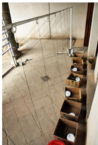
شکل ۴۶- استقرار نخ‌ها بر روی میله نگه‌دارنده دوک جهت چله‌دوانی
