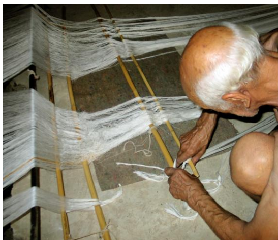
شکل ۶۱- قرار دادن میله‌های چر کار در میان تارها به منظور تفکیک تارهای بالایی و پایینی
