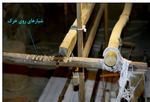
شکل ۱۹- شیارهای سطح بالایی خرک برای تنظیم فاصله دفته
