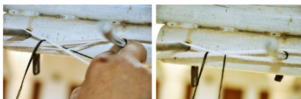
شکل ۵۸- گره‌زدن دسته نخ‌های زیر و رو در محل میله‌های چر کار به منظور ایجاد مشت
