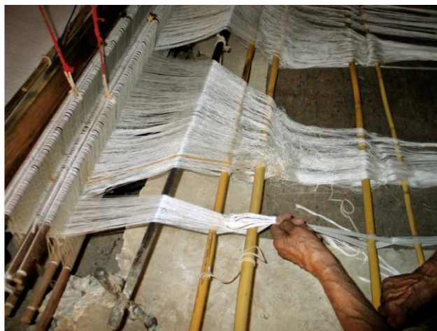
شکل ۶۱- قرار دادن میله‌های چر کار در میان تارها به منظور تفکیک تارهای بالایی و پایینی
