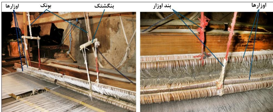
شکل ۳۴- موقعیت بنگشتک، بونک و بند اوزار در دستگاه احرامی بافی
