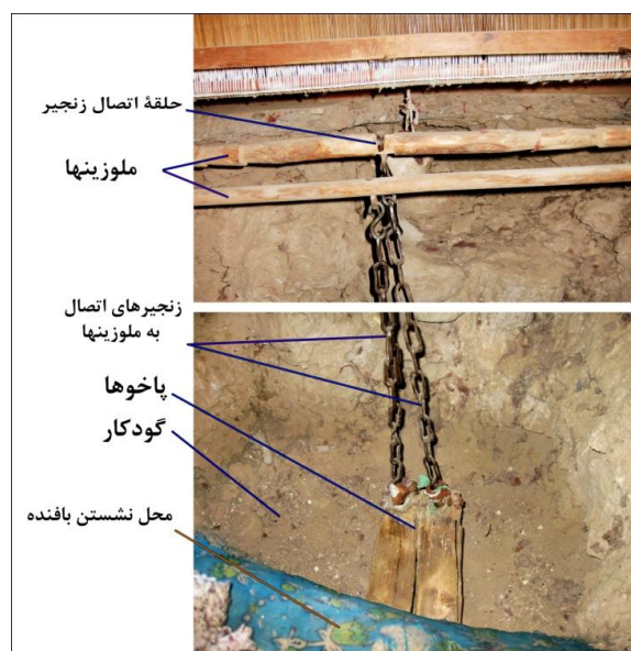
شکل ۳۸- موقعیت پاخواها و ملوزینها در دستگاه احرامی بافی
