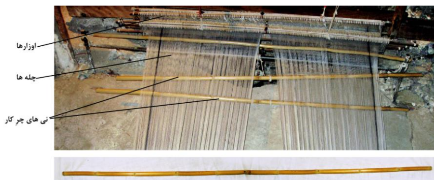
شکل ۳۹- نمای بالا و روبه‌رو از موقعیت نی‌های چر کار در دستگاه احرامی بافی
