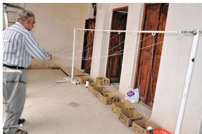
شکل ۴۷- قراردادن قسمت ابتدایی نخ‌ها در دست به منظور تعیین زیر و روی آنها به کمک انگشتان دست
