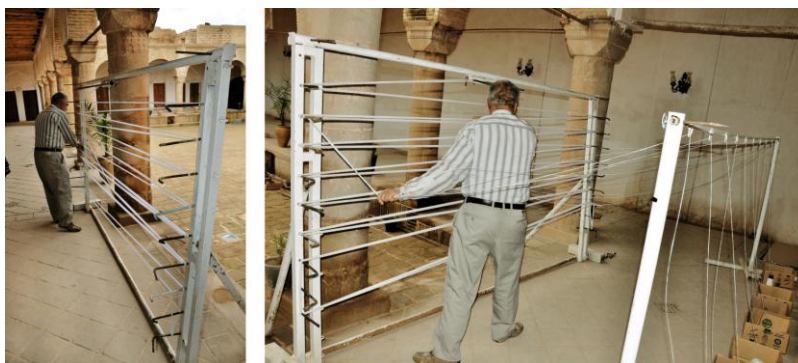
شکل ۵۳- حرکت چله‌ها از میله‌های بخش قلب در پایین به سمت بالا
