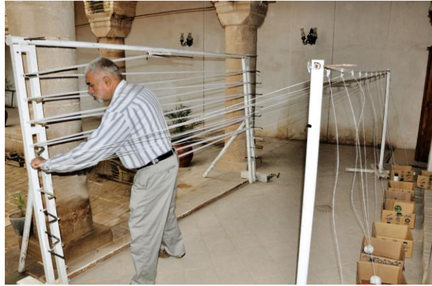
شکل ۵۰- رفت و آمد مداوم چله‌دوان از بالا به پایین، در بین دو میله ریل خط مستقر در سمت چپ و راست
