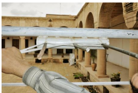
شکل ۵۶- حرکت مجدد دسته نخ‌ها از بالا به پایین، در بین دو میله ریل خط مستقر در سمت چپ و راست
