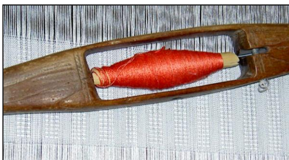
شکل ۶- ماشوره کوچک و نحوه قرا گیری در داخل ماکو
