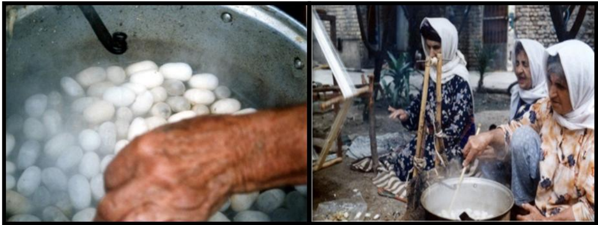
شکل ۱۵- ابریشم کشی در دیگ
