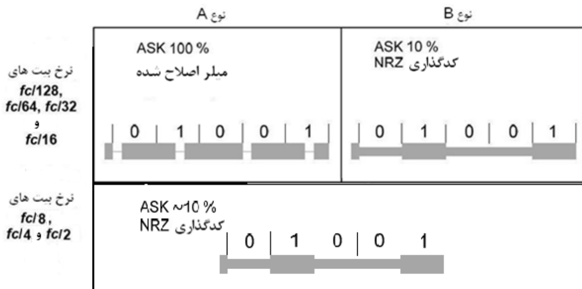
شکل ۱ - مثال سیگنال‌های ارتباط افزاره PCD به کارت PICC برای واسط‌های نوع A و B
