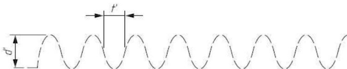
شکل ۷ - اندازه‌گیری شبکه در شکل ۶؛ اندازه‌گیری صحیح فضای اندازه‌گیری، اما با عمق کوچک‌تر ( d' < d )
