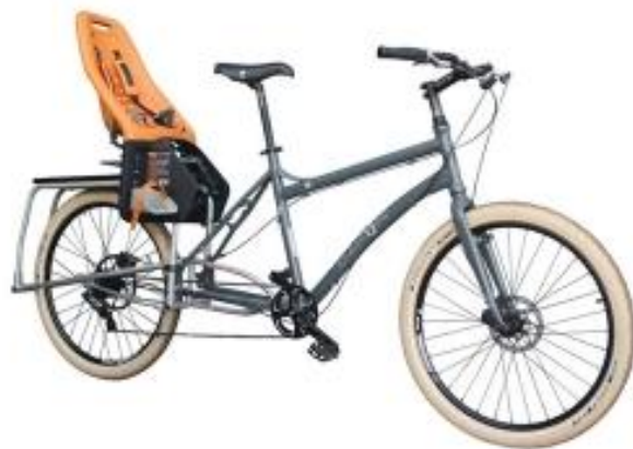
شکل ب-۲- نمونه‌ای از نشیمنگاه عقب متصل شده به دوچرخه
