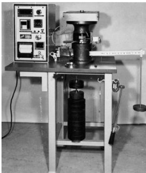
شکل ۳- دستگاه آزمون چهار گلوله
