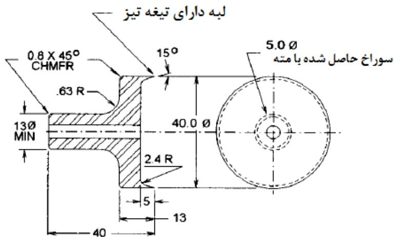
شکل ۲- قالب برش‌دهنده قطعه (فولاد ۴۱۴۰، سختی Rc ۴۰-۴۴ و رواداری  $\pm 3$ )
