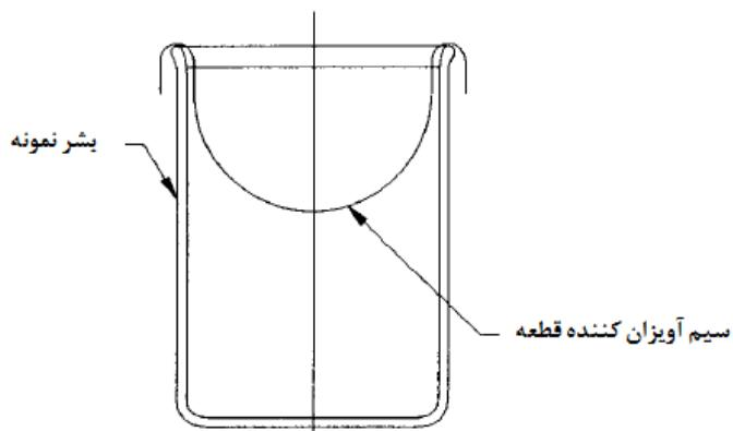
شکل ۱- سیم آویزان کننده قطعه برای نمونه‌های سیال
