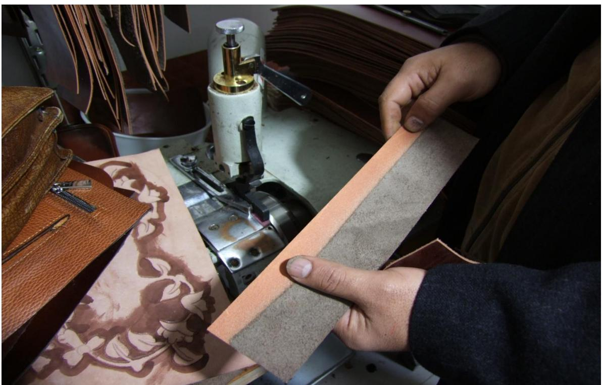
شکل ۳- نحوه نازک کردن چرم برای لبه دوزی
