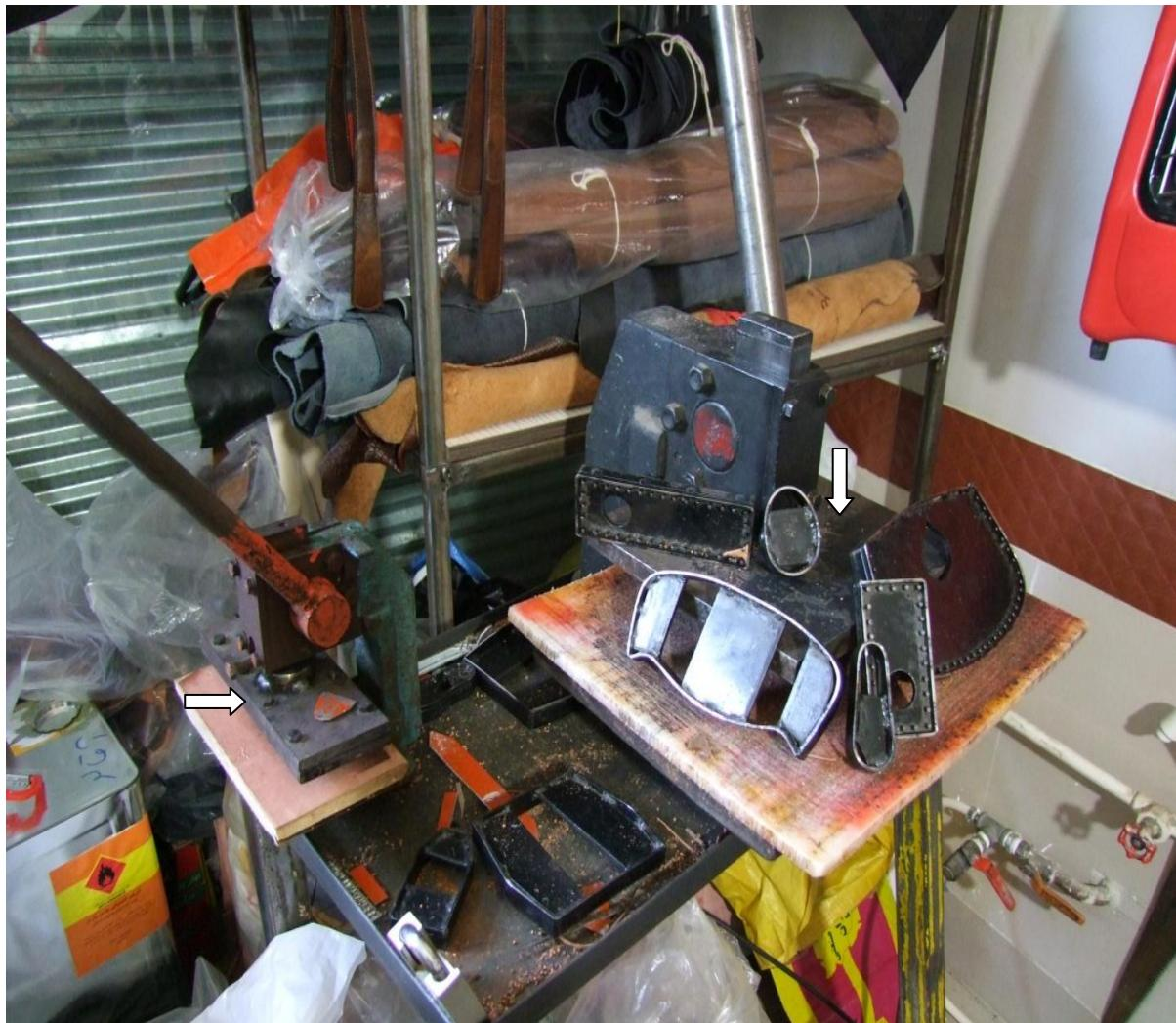
شکل ۴- انواع تیغه برای برش - پرس دستی - داغ کوب
