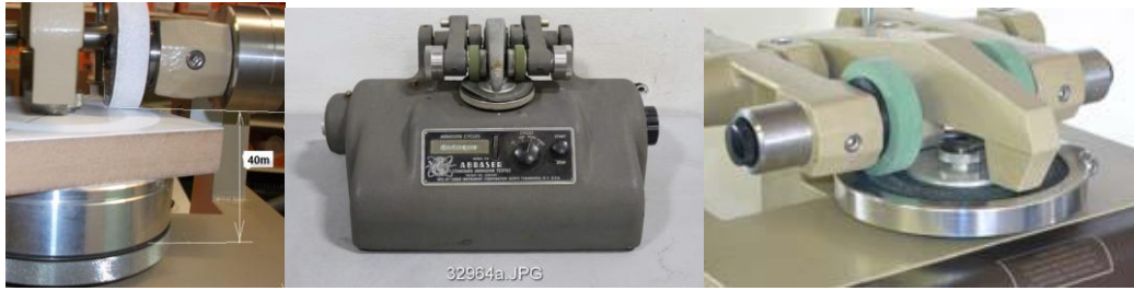
نمونه ای از دستگاه آزمون سایش و نحوه کار آن
