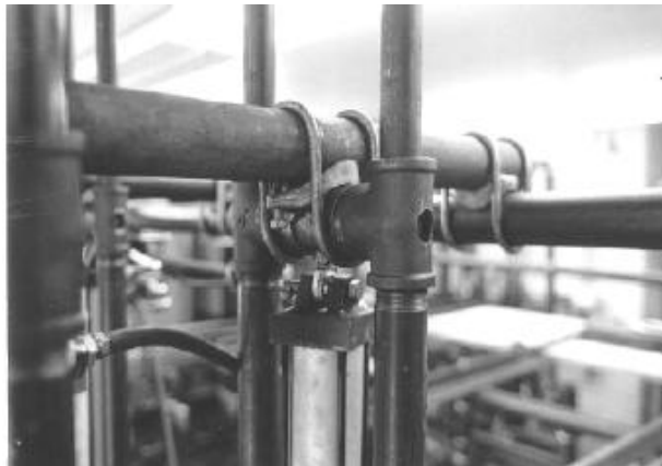
شکل الف-۱۸- چگونگی اتصال سیلندر هوا به قاب ماشین
