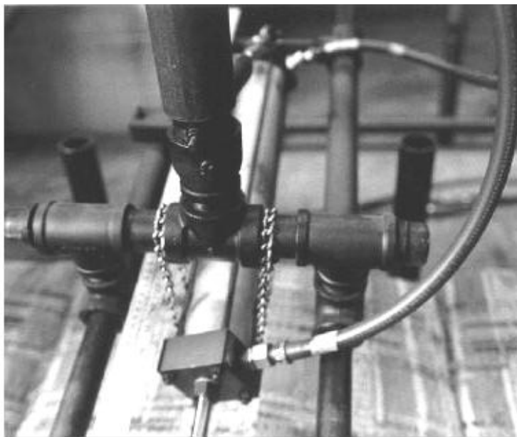
شکل الف-۲۲- اتصال غیر صلب سیلندر هوا به قاب با استفاده از زنجیر
