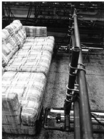
شکل ۷-ب- نحوه قرار گرفتن مبل در قاب ماشین آزمون برای آزمون بارگذاری جلو به عقب پایه‌ها
