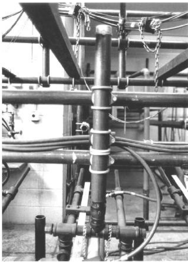
شکل الف-۲۲- اتصال غیر صلب سیلندر هوا به قاب با استفاده از زنجیر
