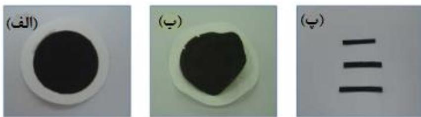
الف ) فیلم CNT با ضخامت فیلم یکنواخت مناسب برای اندازه‌گیری چهار نقطه‌ای،
