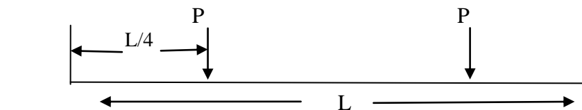
شکل ۲- محاسبه گشتاور خمشی هم‌ارز ایجاد شده در مجموعه بار یکنواخت
