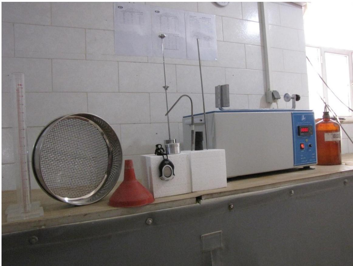
شکل ۱- به ترتیب از راست به چپ بطری، تکان‌دهنده مکانیکی، لوله شستشو، مجموعه میله با وزنه، سیفون، پیمانه اندازه‌گیری، کرنومتر، قیف دهانه گشاد، الک و استوانه مدرج
