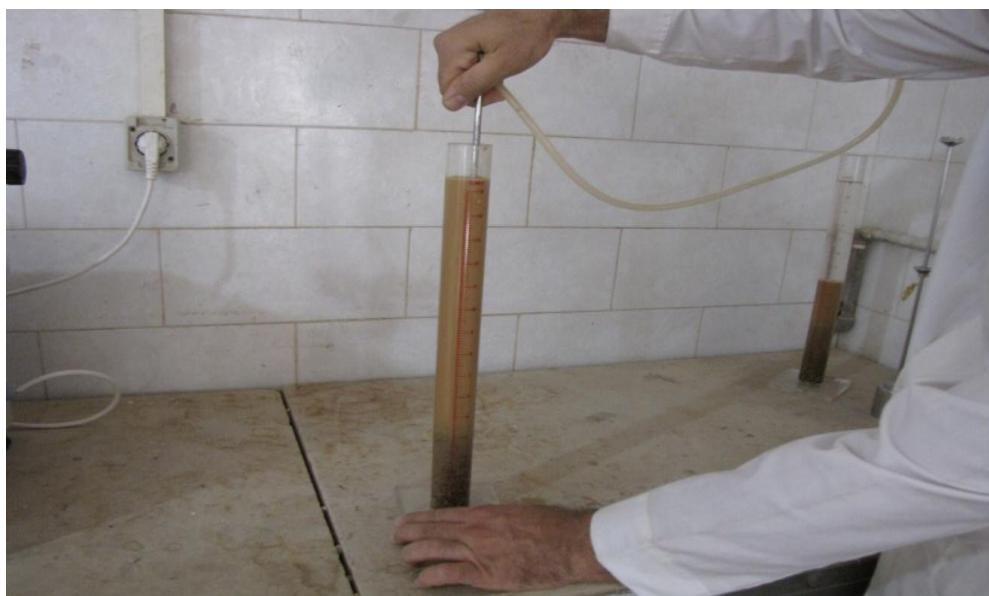
شکل ۹- نحوه قرارگیری استوانه روی میز کار و فرآیند شستشو
