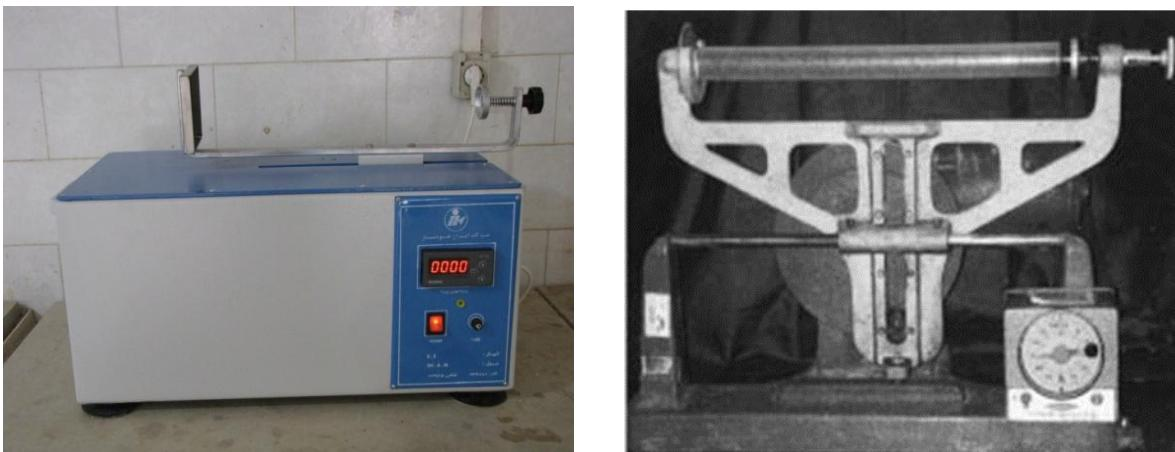
شکل ۳- دستگاه تکان دهنده مکانیکی
