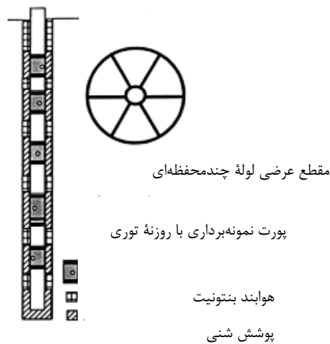
شکل ۵۴- سیستم پایش آب زیرزمینی چندسطحی اختصاصی نوع ۲
