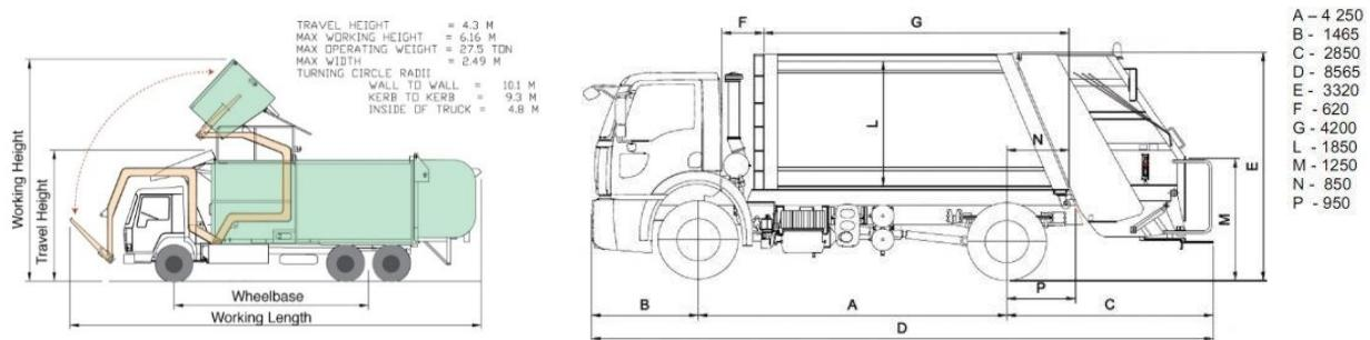
شکل ۴- مشخصات ابعادی و عملیاتی دو نمونه کامیون جمع‌آوری و حمل پسماند شهری
