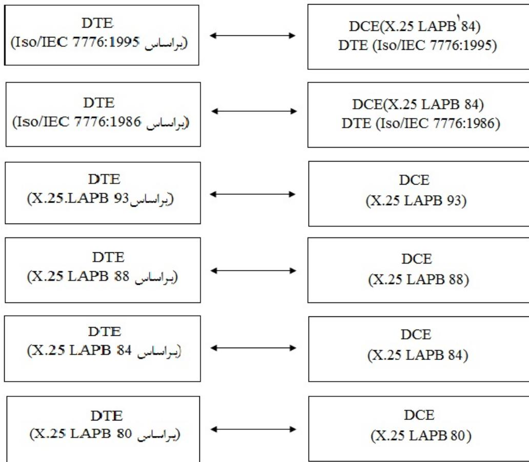
شکل ۱- آزمودن میان کاری بین X.25 DTE/DTE و X.25 DTE/DCE
