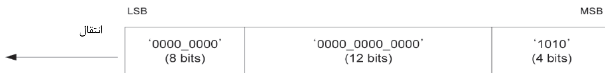
شکل ۱۲ - قالب قسمت آغازی
