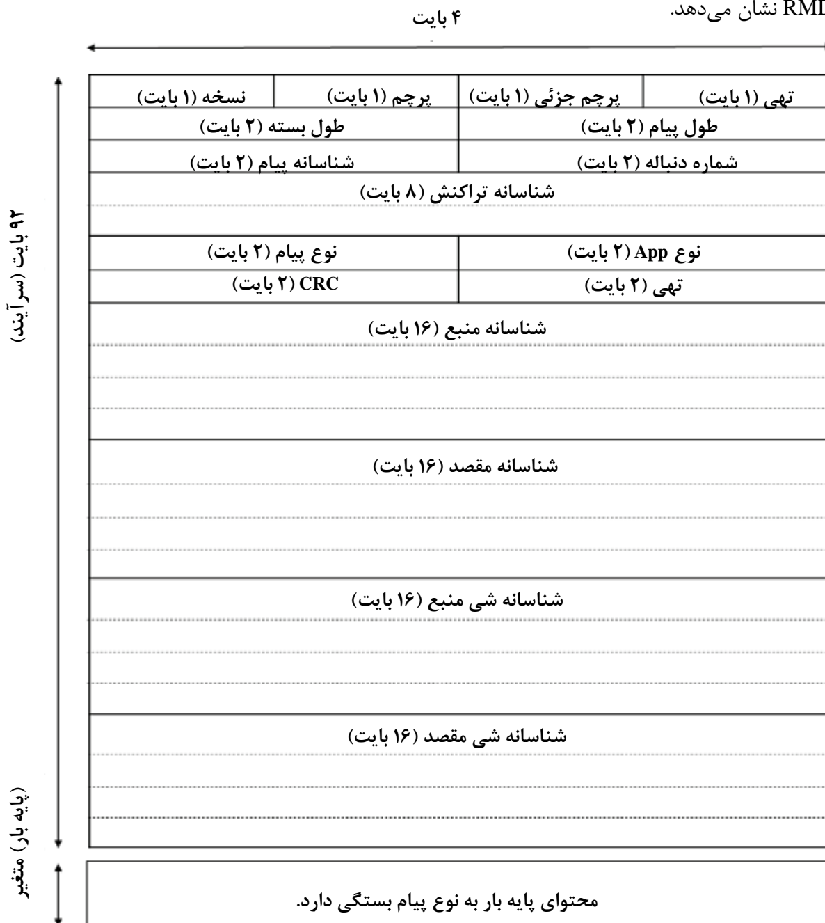
شکل ۸- ساختار سرآیند پیام RMDP
