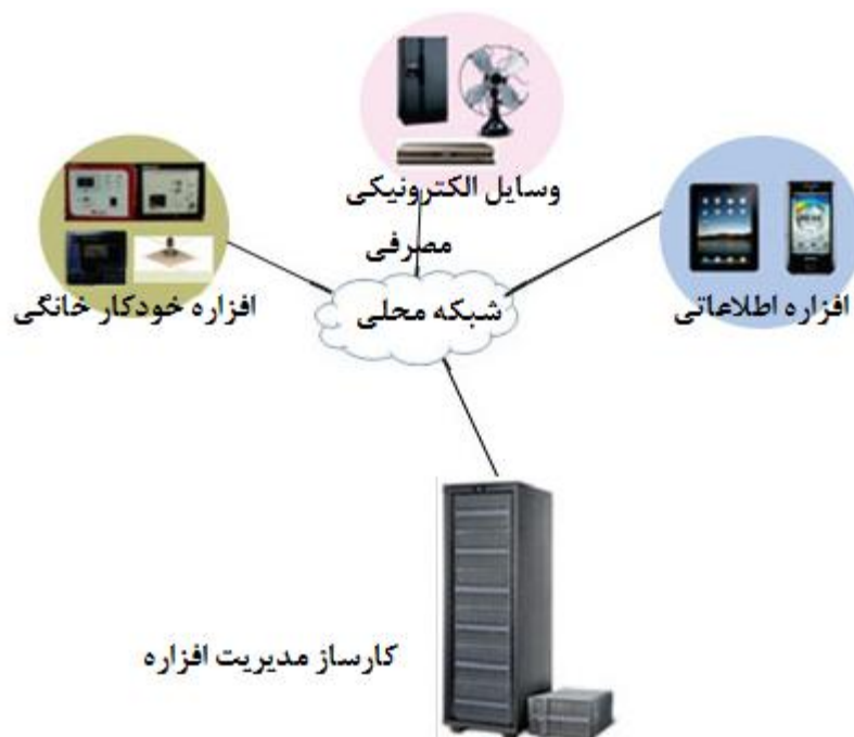
شکل ۲- محیط خدمت DCM- مورد ۱: شبکه محلی با کارساز مدیریت افزاره
