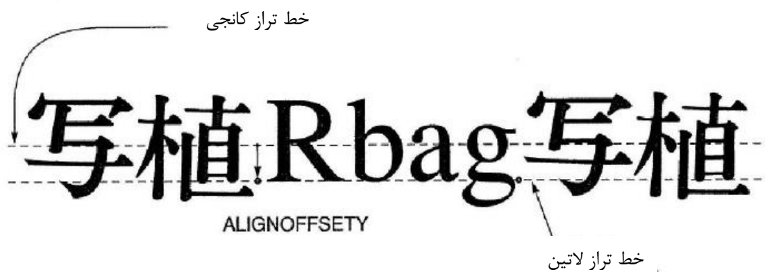
شکل ۴ - مثالی از متن با استفاده از حالت‌های تراز چندگانه در حالت نگارش LEFT-TO-RIGHT (چپ به راست)
