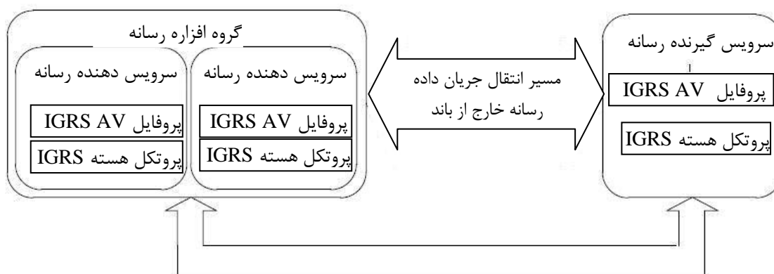
شکل ۳- مدل تعامل سرویس دهندگان رسانه‌های متعدد و سرویس گیرنده رسانه تکی
