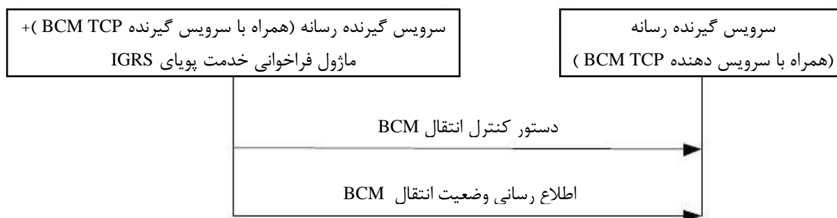
شکل ۱۹- کنترل انتقال اولیه سرویس دهنده رسانه مبتنی بر BCM (ماژول فراخوانی خدمت پویای IGRS مستقر در سرویس دهنده رسانه)
