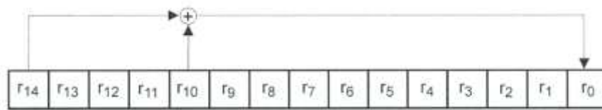
شکل ۲۶- بازخورد دستگاه تغییر مکان برای تولید داده‌ی کد شده
