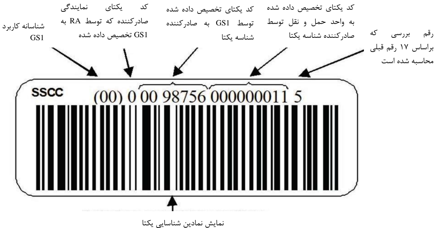
شکل ب-۱ - ارائه شناسه GS1 متعلق به واحدهای حمل و نقل در یک نماد رمزین GS1-128
