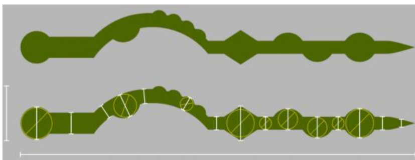
شکل ۳۴- نمونه‌ای از اندازه‌گیری ضخامت نخ
