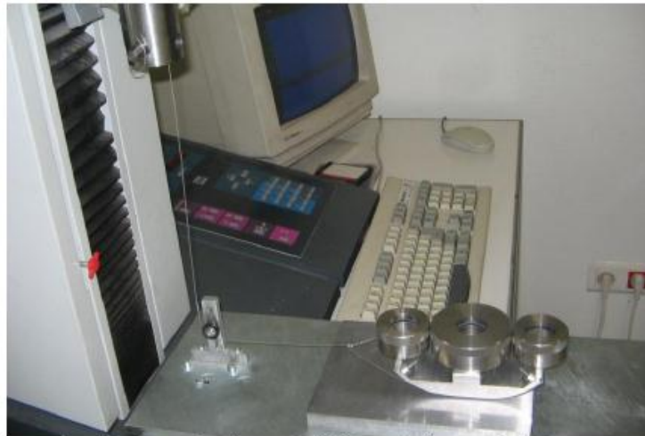
شکل ۱۲- تصویری از تعیین نیروی سرخوردگی (وزنه‌های اضافی بر روی پای آزمون قرار گرفته است)
