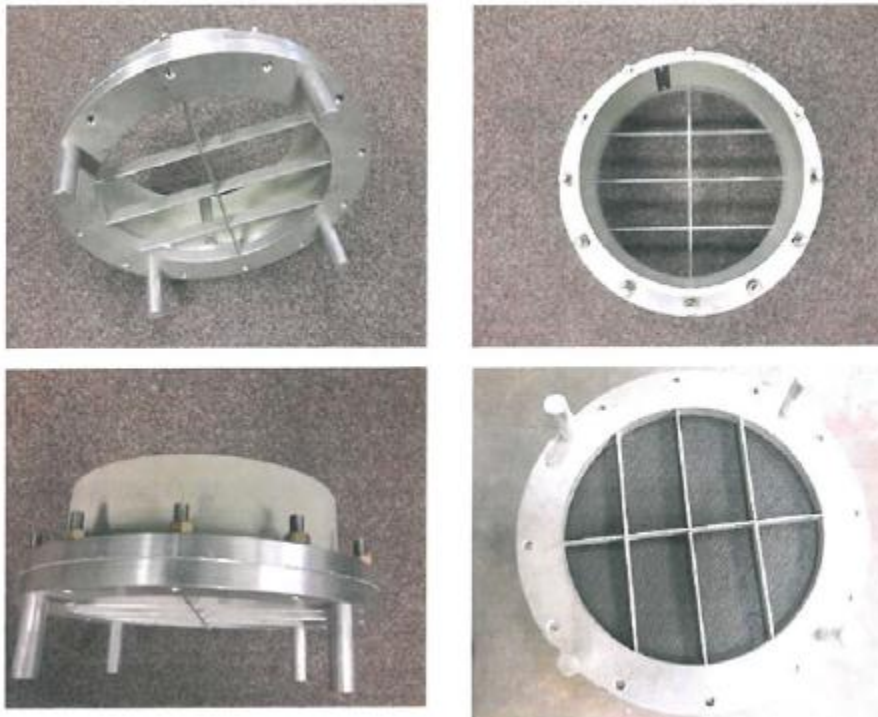
شکل ۳۰- دستگاه تعیین میزان عبور آب
