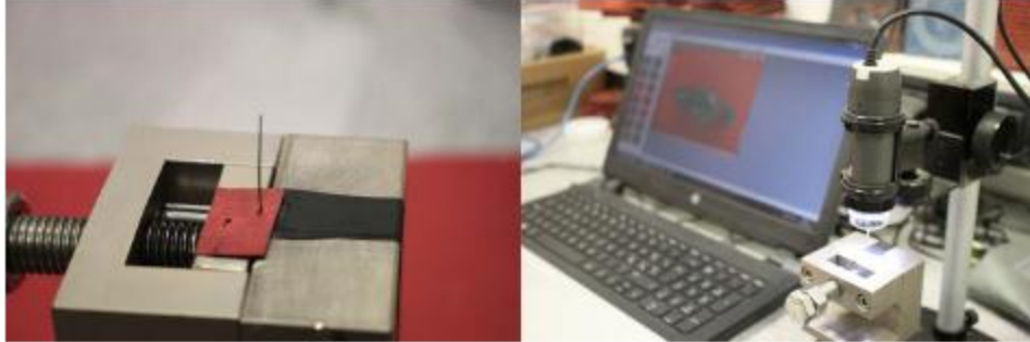
شکل ۳۲- نحوه قرار دادن نمونه زیر میکروسکوپ
