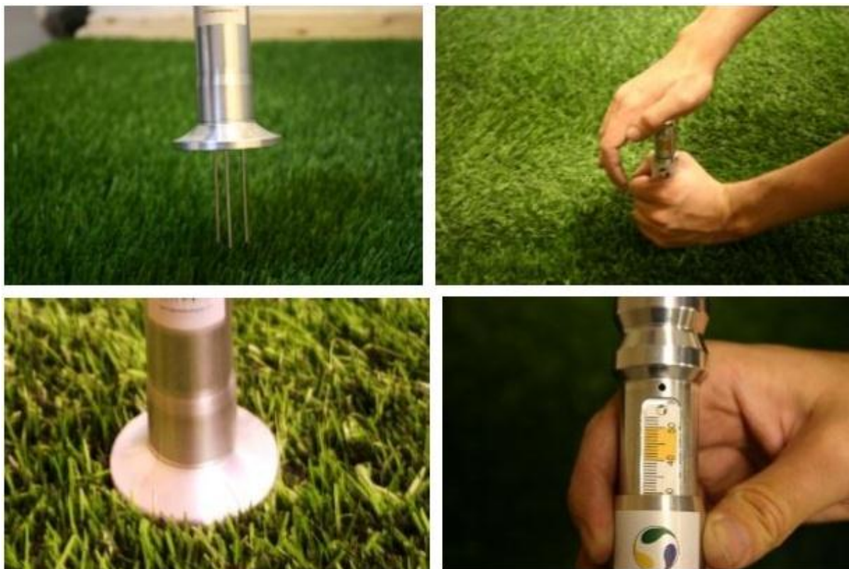
شکل ۲۷- دستگاه عمق سنج برای اندازه‌گیری ضخامت پرکننده
