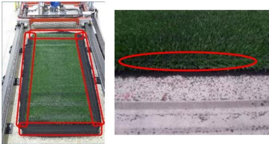
شکل ۱۷- نمونه‌ای از بیرون ریختن و تجمع مواد پرکننده
