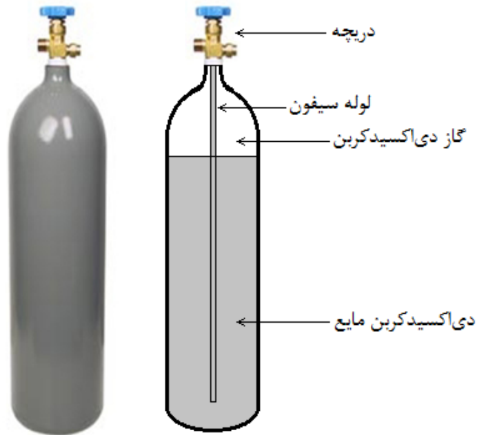
شکل ب ۱- مخزن تغذیه اصلی نوع سیفونی
