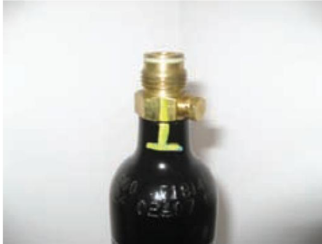
شکل ۶- نمونه علامت مشخصه چرخش دریچه / سیلندر
