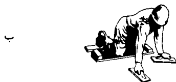
شکل ۶۱. ابزار و روشهای پرداخت سطح بتن ، روش پرداخت با تخته ماله
