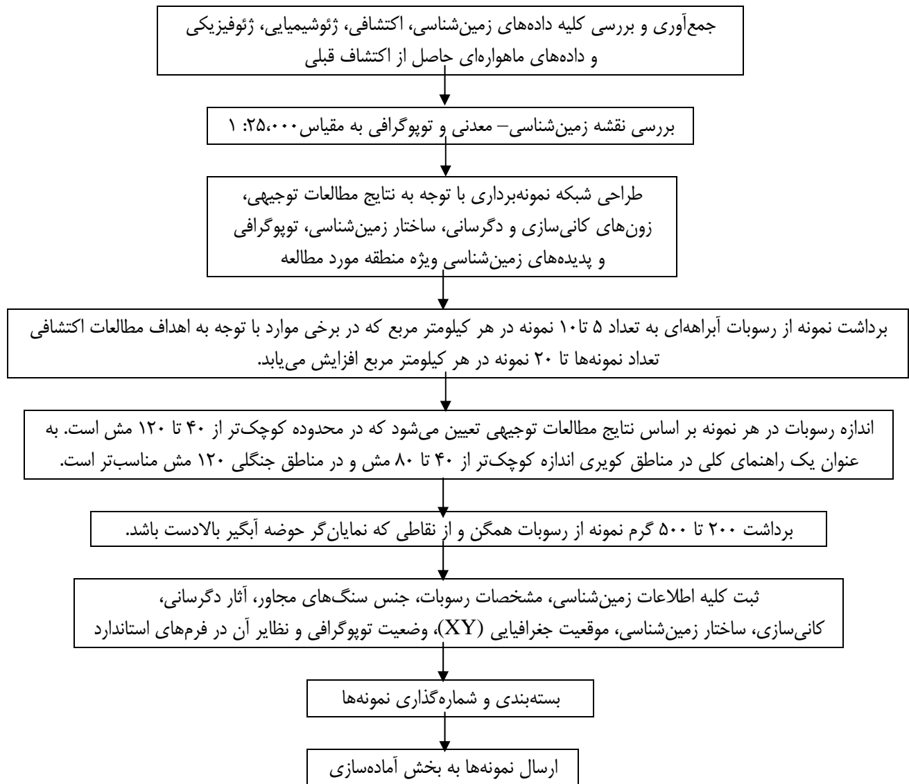
شکل ۲-۴- مراحل طراحی و برداشت نمونه‌های رسوبات آبراهه‌ای.
