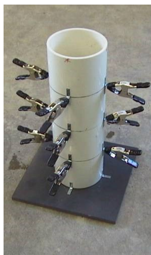
شکل ۳-۹ آزمایش ستون جدادگی مطابق روش ICAR
