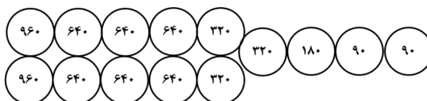
شکل ۸-۶- نحوه چیدمان بشکه‌های ماسه برای یک معبر با سرعت طرح ۱۰۰ کیلومتر بر ساعت
