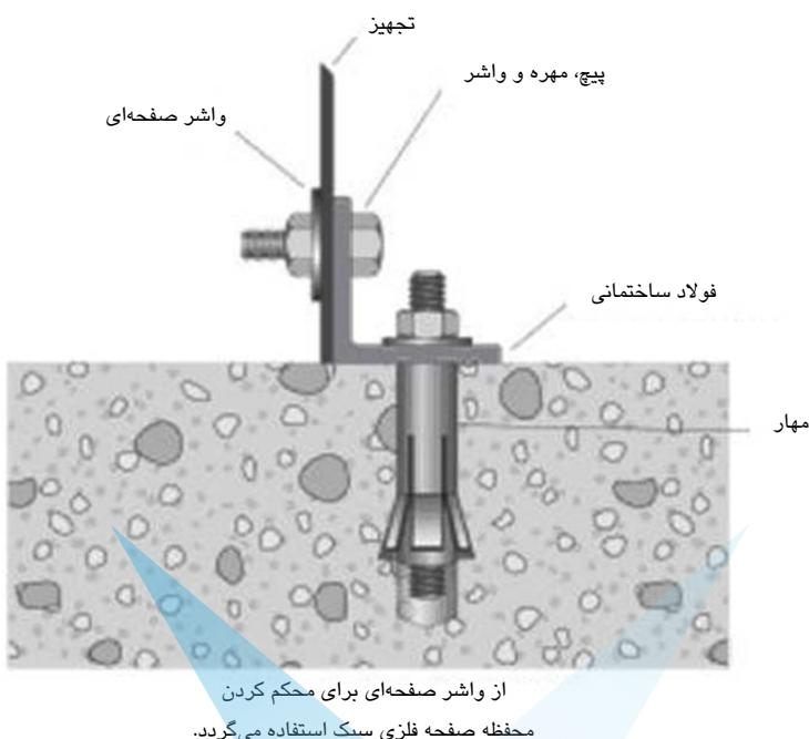
شکل ۱۳۹-۵-اتصال تجهیزات به یک نبشی با پیچ
