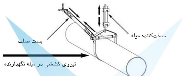
ب- نمونه‌ای از اتصال با میله صلب که باعث ایجاد نیروی کششی در آن می‌شود
