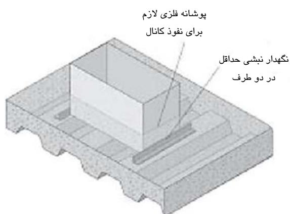
شکل ۵-۹۹- عبور کanal از پوشش فلزی سقف
