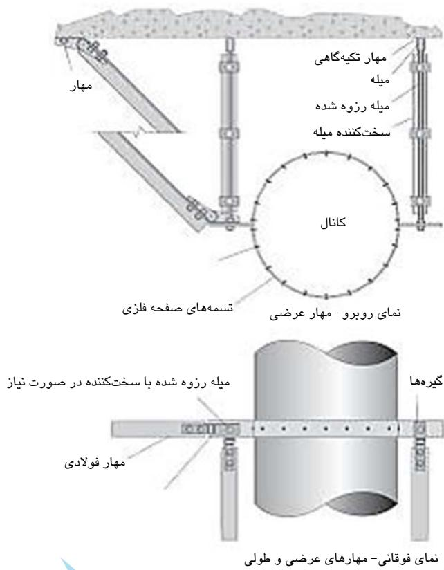
شکل ۵-۷۹- کanal دایروی با میله‌های قائم و مهاربندی شده با پروفیل فولادی (عرضی و تمام جهته)
