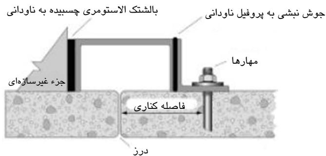
شکل ۴۱-۵- ضربه‌گیر نصب شده در نزدیکی درز اجرایی بتنی
