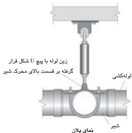
شكل ۵-۱۷۰-۵- مهاربندی محرک شیر
