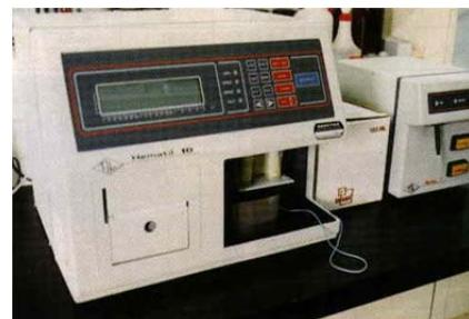
شکل ۱-۱۴۹- شمارش گر اتومکانیک سلول (Automatic cell counter)
