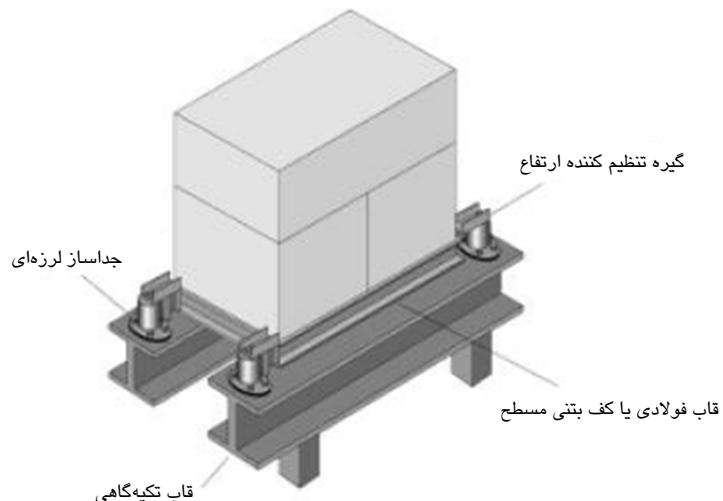
شکل ۵-۵-۵- سیستم اتصال فنر مقید برروی قاب تراز
