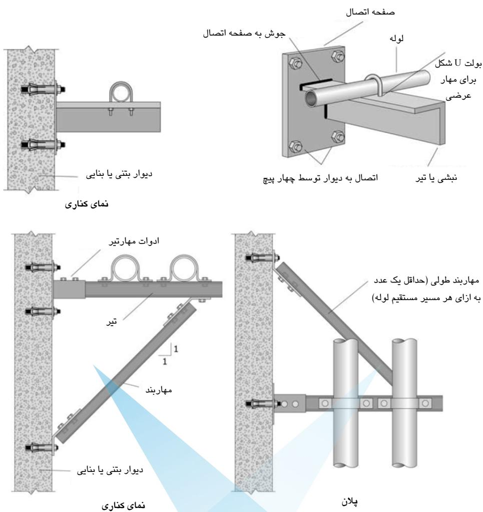
شکل ۱۲۱-۵- اتصال به دیوار با استفاده از نبشی جوش داده شده به صفحه اتصال
