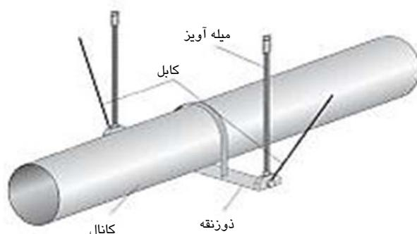
شکل ۵-۷۸-۵- کanal دایروی اختیاری با میله‌های قائم و مهاربندی از طریق کابل
