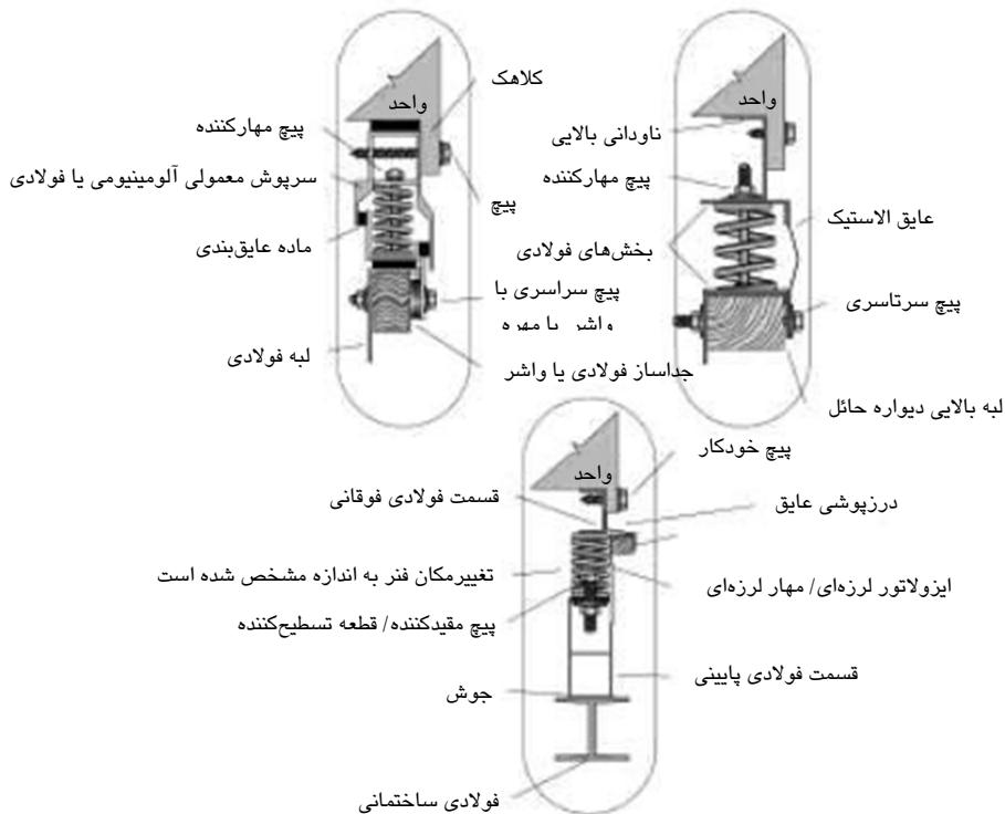
شکل ۵-۵- انواع سیستم‌های ایزولاتور
