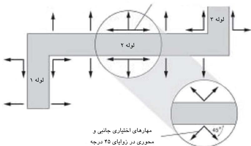
شکل ۵-۷۰- انتخاب مهاربندی کانال‌ها - لوله‌ها و تجهیزات موجود در مسیر
