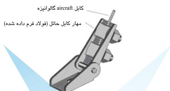
شکل ۱۴۶-۵- کابل متصل شده به سگدست با پیچ
