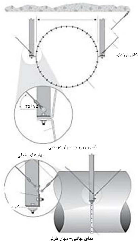
شکل ۵-۸۰- کanal دایروی با پروفیل فولادی عمودی و مهاربندی توسط کابل (عرضی و طولی)
