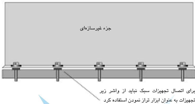
شکل ۳۰-۵- نمای جانبی تجهیزات دارای تکیه‌گاه صفحه‌ای فولادی
