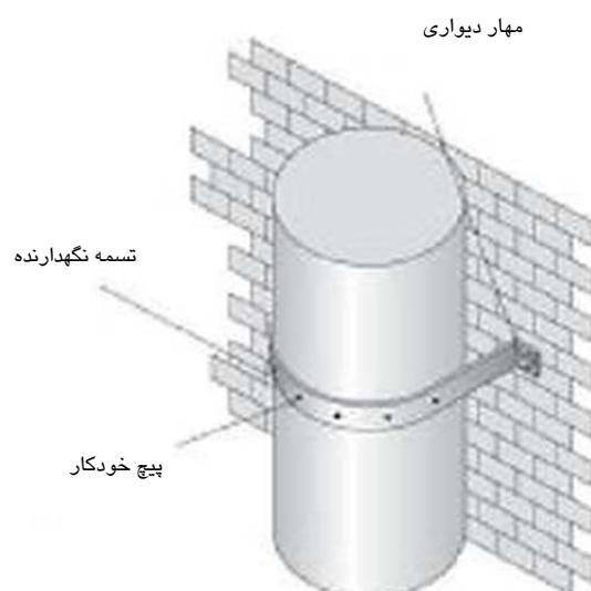
شکل ۹۵-۵- تسمه متصل شده به صورت مستقیم به دیوار
