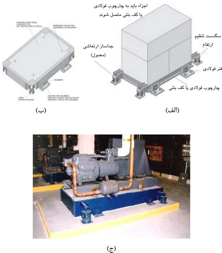
شکل ۶۱-۵-الف) نحوه نصب رایج یک جداساز ارتعاشی غیرمقید با snubber. ب) چارچوب فولادی پرشده با بتن. ج) نمونه‌ای از نصب سیستم فنر آزاد همراه با snubbers
