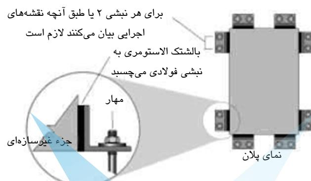
شکل ۵-۴۰- تجهیزات نصب شده با ضربه‌گیر
