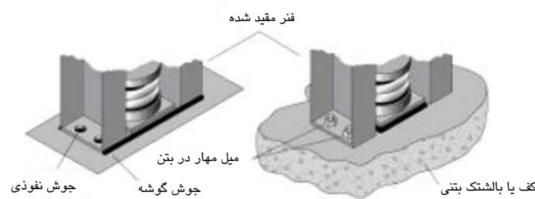
نمونه اتصال پیچی بتن کف یا بالشتک بتنی
