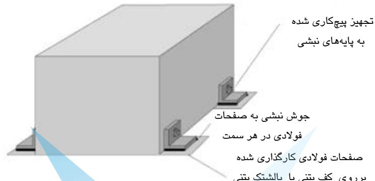
شکل ۵-۳۶- استفاده از چهارنбشی یا بیشتر برای اتصال به طبقه (جوش شده به سازه و پیچ شده به تجهیزات)
