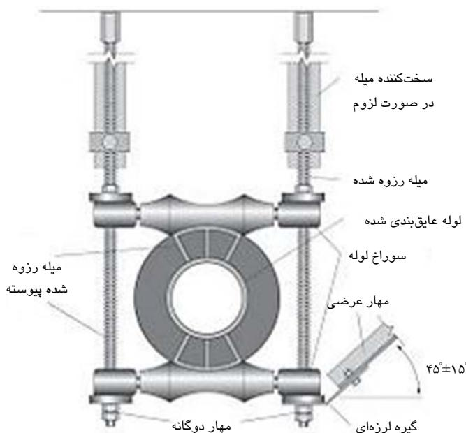
شکل ۵-۱۱۳- تکیه‌گاه دوغلتکی برای لوله‌های اشباعی حرارتی
