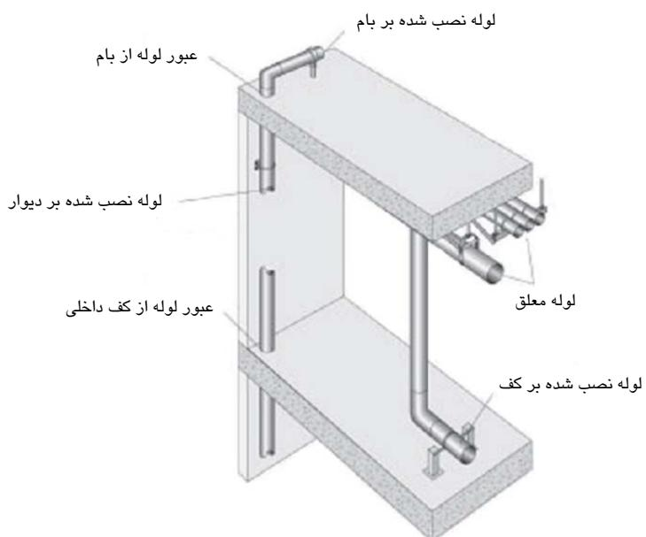
شکل ۷۲-۵-سیستم لوله‌کشی با انواع مهاربندی لرزه‌ای
