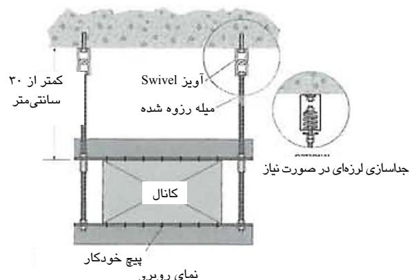
شکل ۸۲-۵- تکیه‌گاه میله‌ای غیر مقاوم در برابر لنگر برای کanal مستطیلی تکیه‌گاه تسمه‌ای
