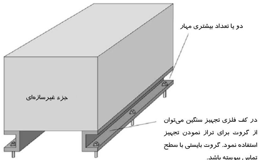
شکل ۵-۳۱-۵- اتصال مستقیم تجهیزات دارای قاب / پایه فولادی
