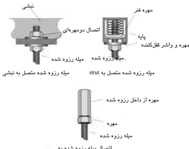
شکل ۱۴۱-۵- اتصال میله رزوه شده به سقف
