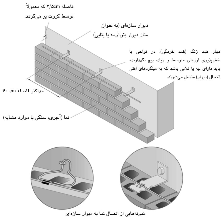
شکل ۵-۴- نمای مهار شده توسط اتصالات مکانیکی
