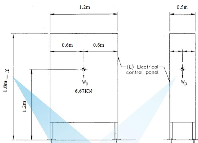
شکل ۲۸-۶- نمای شماتیک کنترل پانل
