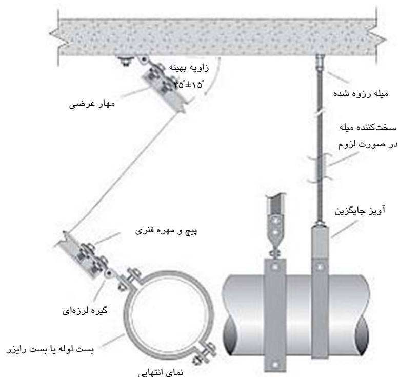
شکل ۵-۱۰۶- گیره‌های نگهدارنده لوله با استفاده از پایه‌های عرضی یا نبیشی به عنوان مهاربند عرضی و میله آویز
