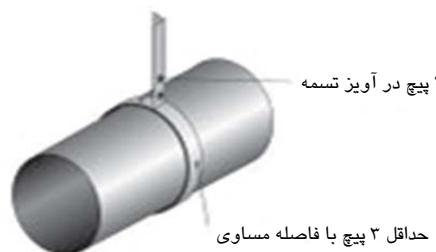
شکل ۵-۸۵- مهار تسممهای برای کanal دایروی با مهاربندی فولادی
