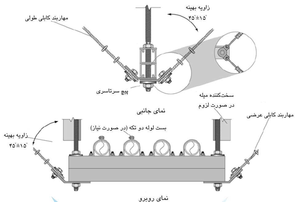
شکل ۵-۱۱۲-۵- سیستم نگهدارنده ذوزنقه‌ای با مهاربند کابلی جانبی
