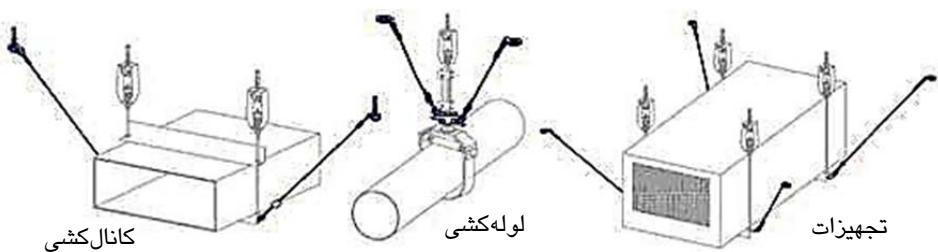
شکل ۱-۵- نمونه‌هایی از مهارهای مورد استفاده تجهیزات
