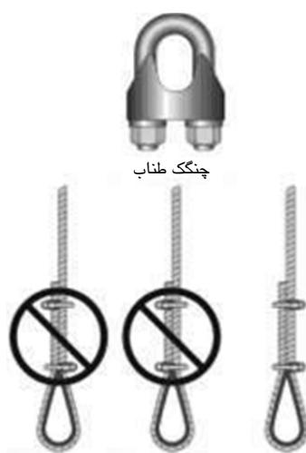
شکل ۵-۱۴۹-۵- روش مناسب چنگک طناب سیمی
