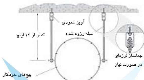
شکل ۸۴-۵- کanal دایروی و تکیه‌گاه میله‌ای غیر مقاوم در برابر لنگر
