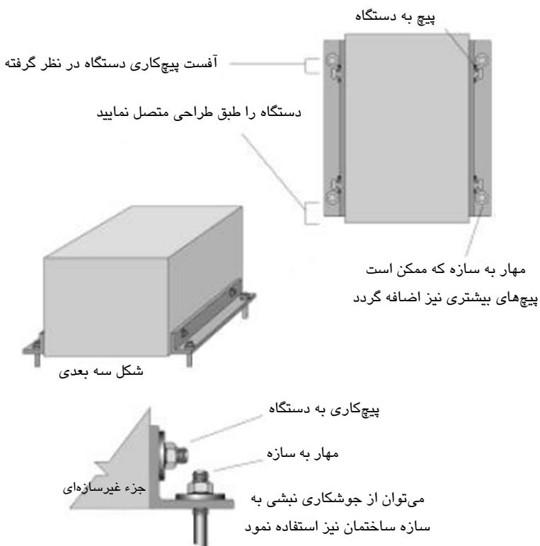
شکل ۳۳-۵- استفاده از نبشی برای متصل کردن تجهیزات به ساختمان
