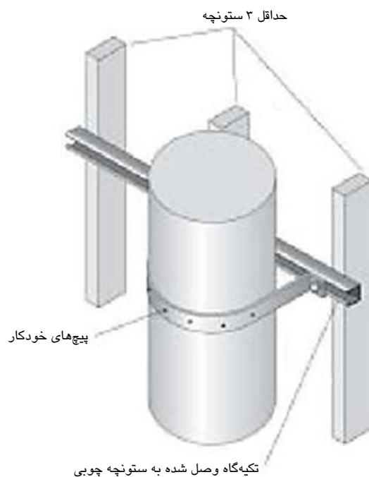
شکل ۵-۹۷- کanal نگهداری شده از طریق ستونچه چوبی یا فلزی متصل به دیوار
