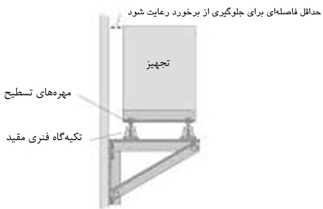
شکل ۵-۶۴- تجهیزات ایزووله شده روی دیوار
