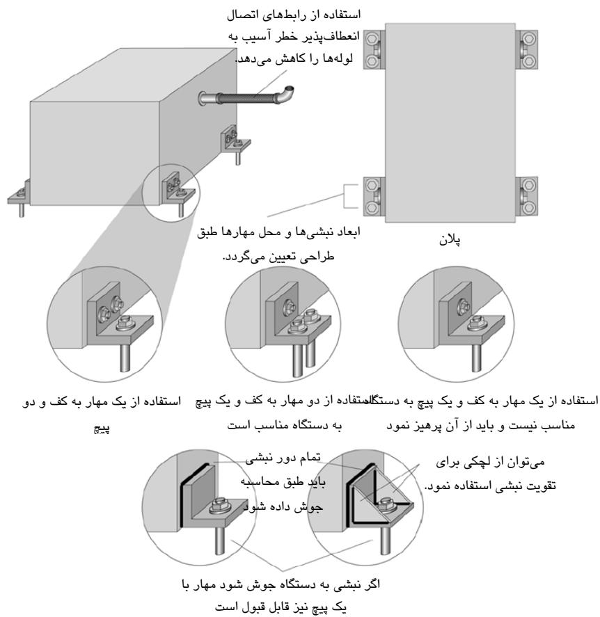
شکل ۵-۳۵- نحوه اتصال نبشی به جزء غیرسازه‌ای
