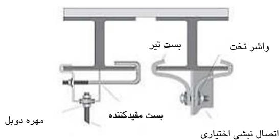
شکل ۵-۱۴۳-۵- طرز اتصال مهار به تیر I شکل
