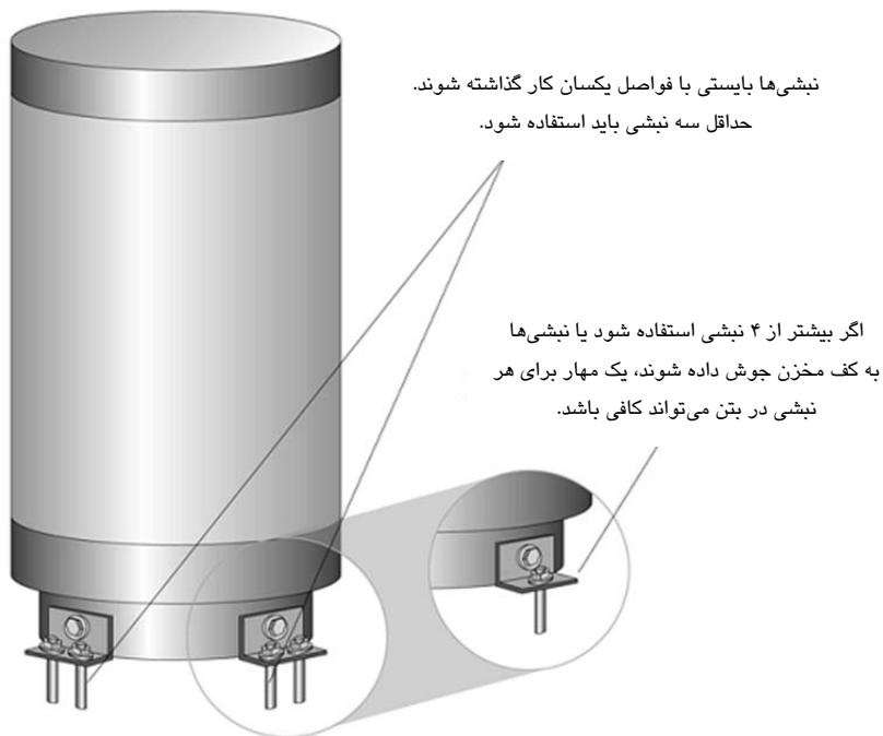
شکل ۵-۳۸-۵- استفاده از سه‌نبشی یا بیشتر برای تجهیزات با پایه مدور و استوانه‌ای
