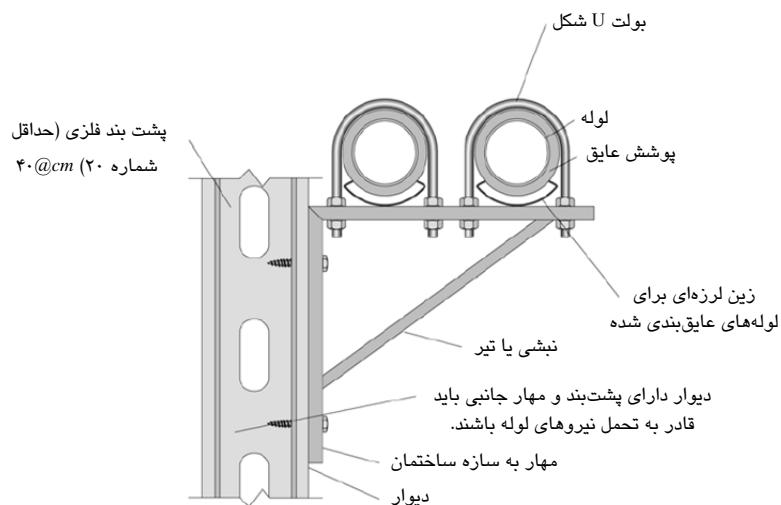
شکل ۱۲۲-۵- اتصال به گل میخ‌ها در دیوار با گیره‌های پیش‌ساخته
