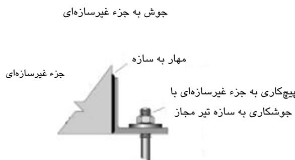
شکل ۳۴-۵- استفاده از نبشی برای اتصال به طبقه (جوش شده به تجهیزات و پیچ شده به سازه)
