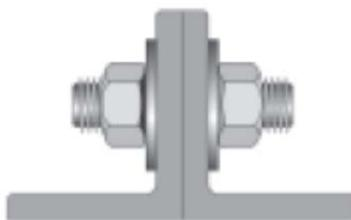
شکل ۱۴۰-۵- پیچ نمودن پروفیل‌های فولادی
