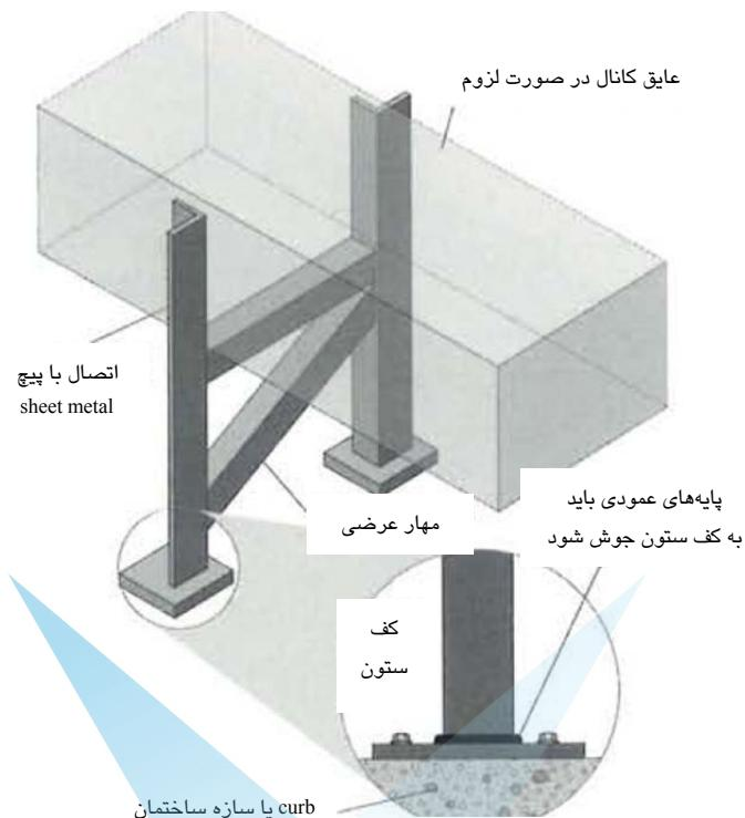
شکل ۵-۹۲- کanal نصب شده بر روی بام با استفاده از قاب مهاربندی شده
