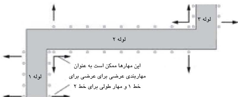
شکل ۶۹-۵- یک روش مقرر یون به صرفه برای آرایش مهاربندی‌ها
