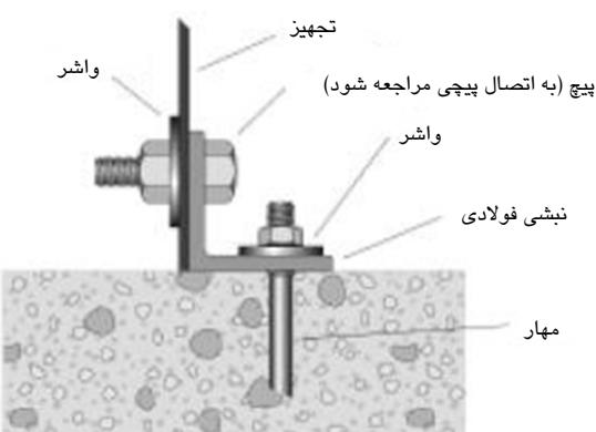
شکل ۱۳۳-۵- اتصال مهار با قطر بیشتر از  $10\text{mm}$  به تجهیزات
