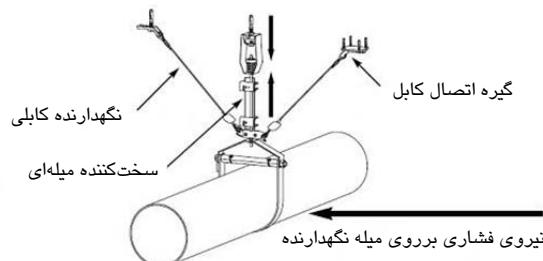
الف- نمونه‌ای از اتصال لوله‌ها با کابل که سبب ایجاد نیروی فشاری در میله نگهدارنده می‌شود.
