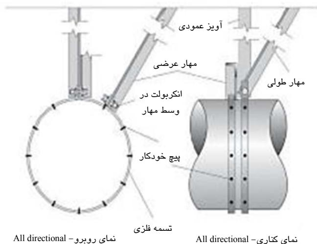
شکل ۵-۸۱- کanal دایروی با پروفیل فولادی قائم و مهاربندی فولادی چند جهته
