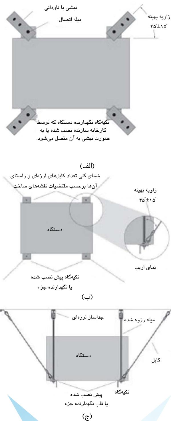
شکل ۵-۵۵- (الف) اتصال صلب نیشی ها به سازه، (ب) نمای پلان یک اتصال دارای جدا ساز لرزه ای، (ج) نمای جانبی اتصال سازه
