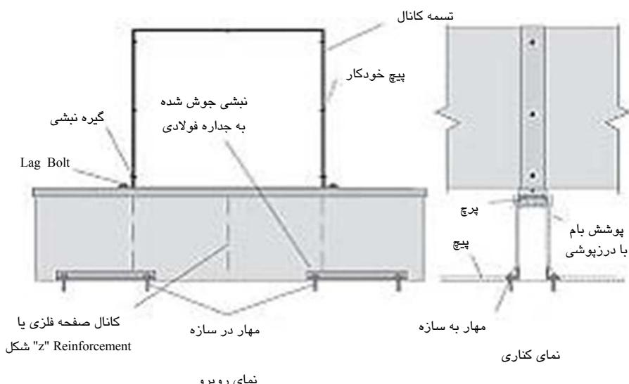
شکل ۵-۹۱- کanal نصب شده بر روی یک مهار لرزه ای پیش ساخته برای کanal
