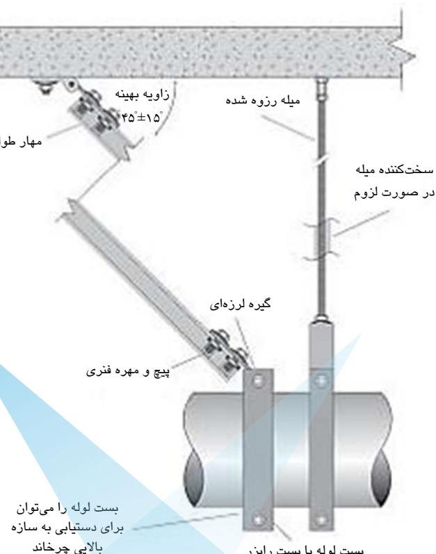
شکل ۵-۱۰۷- نگهدارنده بست لوله با پایه طولی یا نبشی مهاربند طولی و میله آویز
