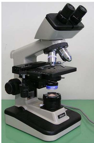
شکل ۱-۱۵۸- میکروسکوپ (Microscopes)
