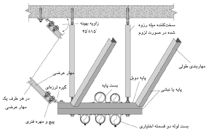
شکل ۵-۱۱۱-۵- سیستم نگهدارنده ذوزنقه‌ای با پایه و نبشی به عنوان مهار جانبی
