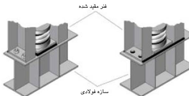
نمونه اتصال فولادی پیچی به سازه
