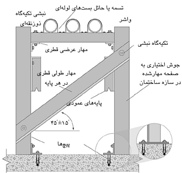
شکل ۱۱۶-۵- اتصال به کف با استفاده از فولاد ذوزنقه‌ای
