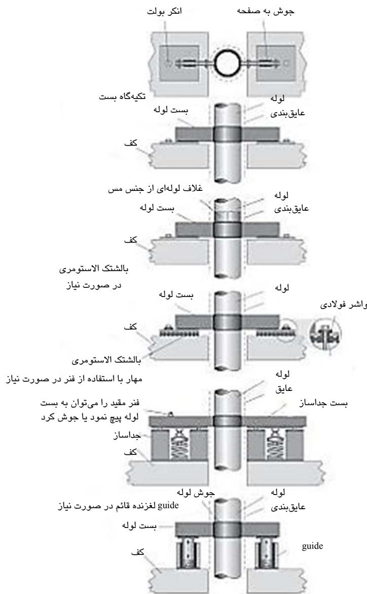
شکل ۱۲۶-۵- جزئیات عبور لوله از طبقات میانی با روشهای مختلف در صورت نیاز
