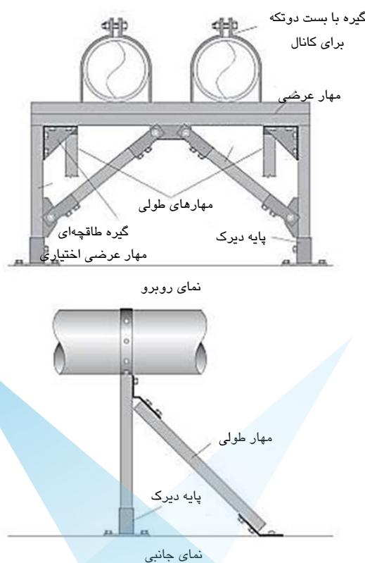
شکل ۱۱۵-۵- اتصال به کف با استفاده از تکیه گاه ذوزنقه‌ای
