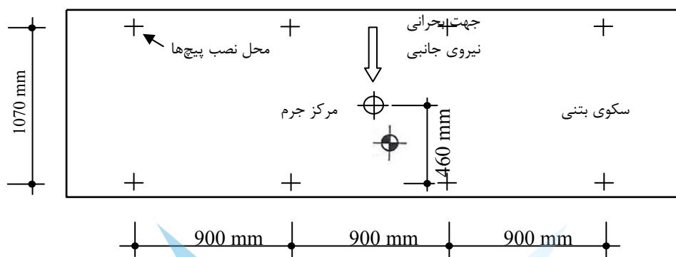
شکل ۶-۲۶- پلان شماتیک چیلر و محل نصب پیچ‌ها
