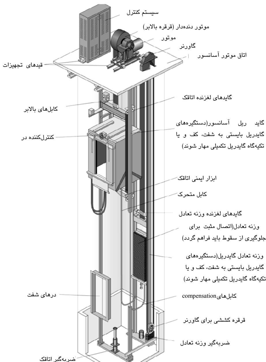
شکل ۵-۲۸- نمای شماتیک سیستم آسانسور کابلی دندهدار
