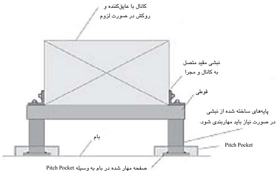
شکل ۹۳-۵- کanal نصب شده بر یک تکیه‌گاه نبشی متصل شده به بام به طور مستقیم در Pitch Pocket
