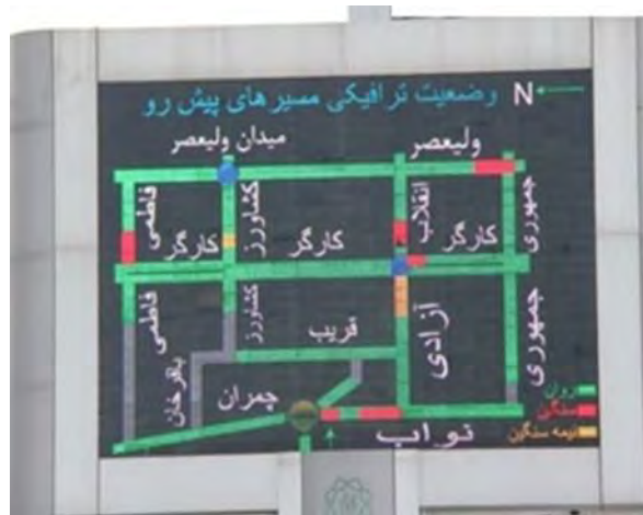
شکل ۱-۲: یک نمونه تابلوی متغیر خبری (از نوع بیل‌بورد) تمام‌رنگی LED نصب‌شده کنار معبر و نشان‌دهنده اطلاعات ترافیکی مسیر
