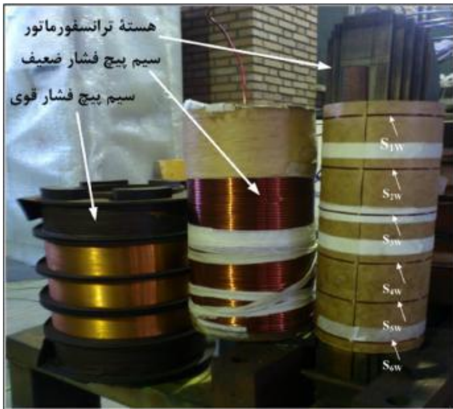
شکل ۲-۲۷: حسگرهای نصب شده بر روی هسته ترانسفورماتور نمونه در فاز W
