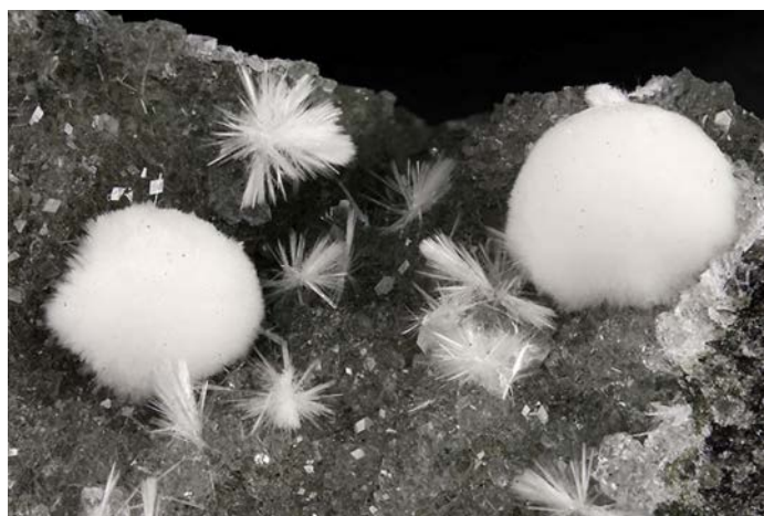
شکل ۷-۱- ساختار بلوری توبرموریت و زونولیت
