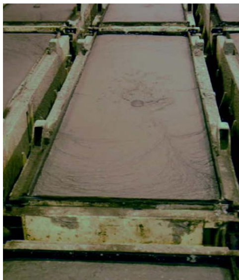
شکل ۱-۴- افزایش حجم کیک خام در قالب
