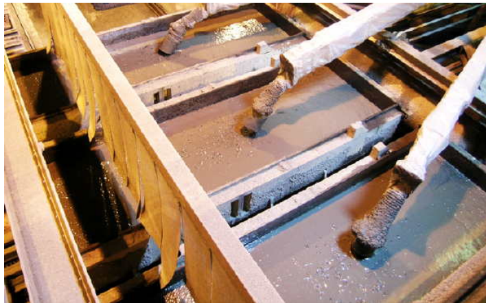
شکل ۱-۲- ریختن دوغاب به درون قالب‌ها
