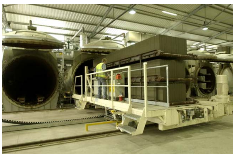
شکل ۱-۶- بلوک‌های خام به درون اتوکلاو تغذیه می‌شوند
