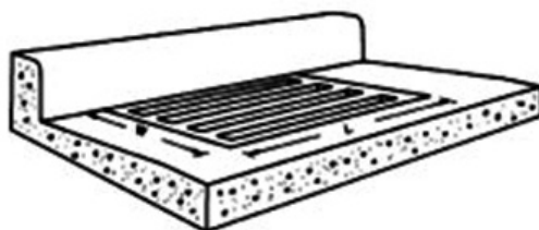
تصویر (۷/۱): نمای شماتیک آبگذر کف - تیپ G
