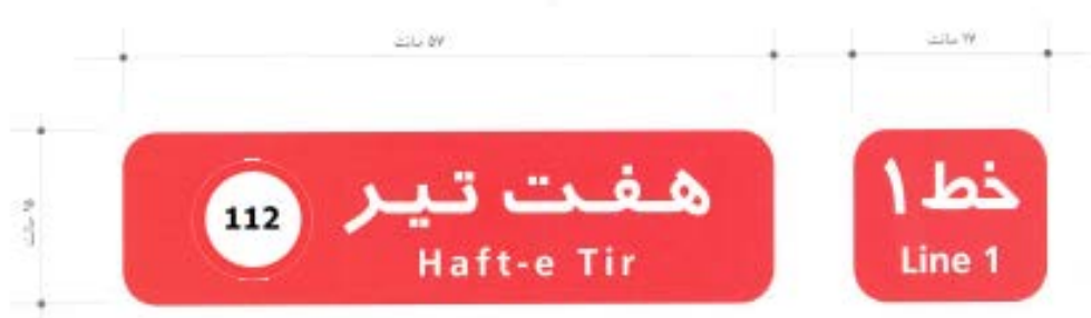
شکل ۸-۴ نشانه نام خط و ایستگاه
