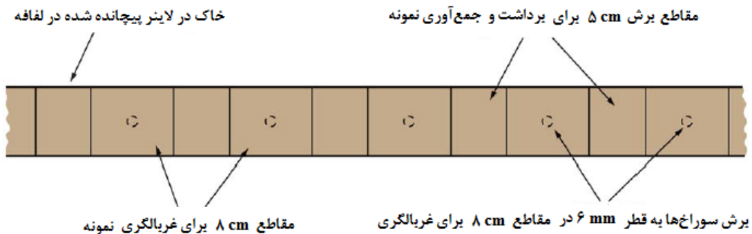
شکل پ-۳- پیکربندی لاینر برای روش نمونه‌برداری خاک زیرسطحی مقطعی
