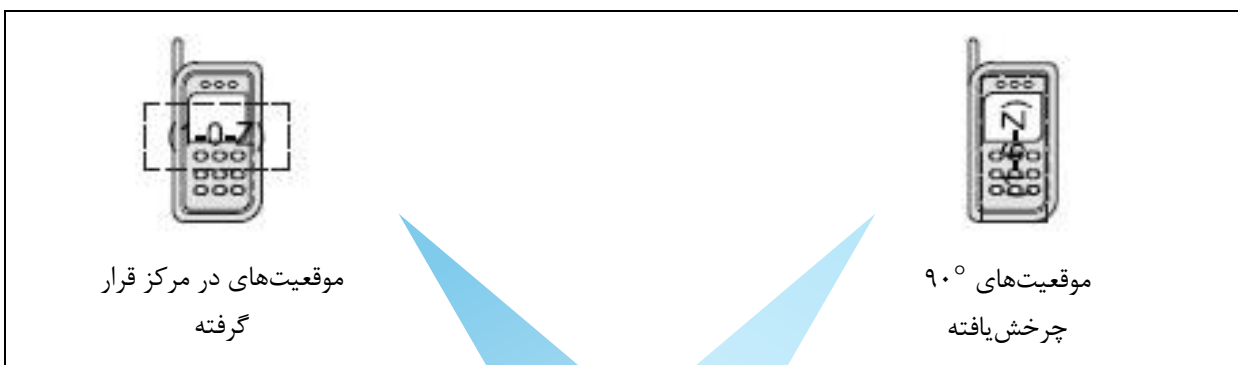
شکل ۳- موقعیت‌های اندازه‌گیری برای طرح مدرک خوان نوع M
