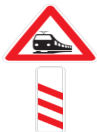
ح: تقاطع جاده و راه آهن بدون راه بند نصب در ۳۰۰ متری
